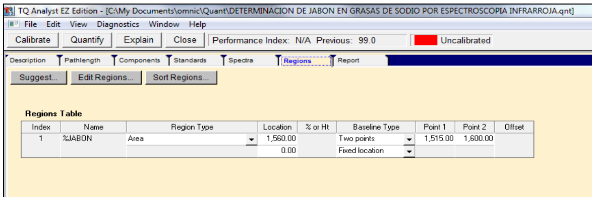
Figura 24. Pantalla del software TQ Analyst con la descripción del tipo de región, localización de la banda de cuantificación, el tipo de línea base y los puntos seleccionados para la línea base (ídem, 2013)
