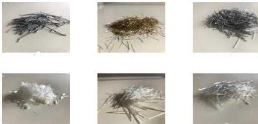
*Ilustración 1. Tipos de fibras usados para el UHPFRC [3].*
