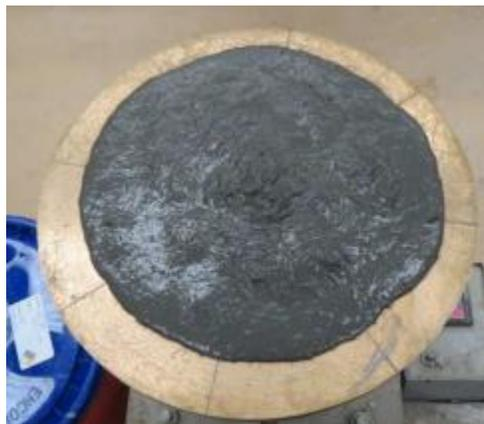
Ilustración 10. Mezcla sin tixotropía [6].
