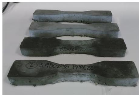
Ilustración 2. – Cuerpo de prueba “dogbone” para ensayo a tracción directa conforme a JSCE-08 [4,5].
