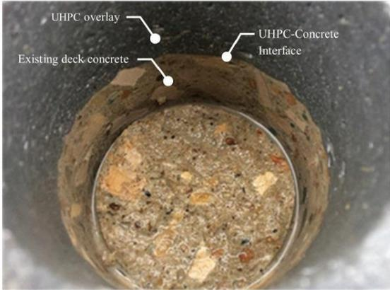
Ilustración 44. Vista del espacio ocupado por los cilindros, diferencia entre sustrato de concreto y UHPC [12].
