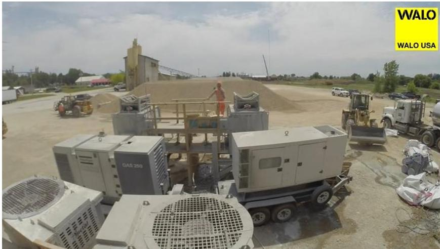
*Ilustración 61. Planta en sitio para la fabricación del UHPFRC [24].*
