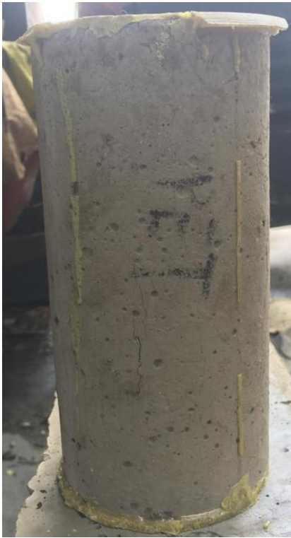
Imagen 20. Probeta fallada a compresión axial a los 28 días.
