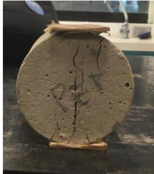
Imagen 33. Mezcla 2, probeta fallada a tensión indirecta a los 28 días.
