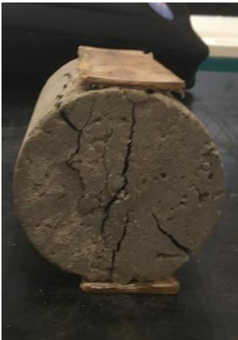
Imagen 32. Mezcla 1, probeta fallada a tensión indirecta a los 28 días.
