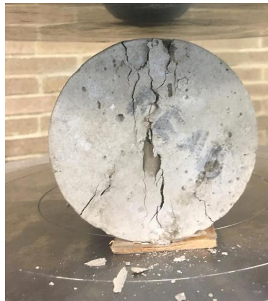
Imagen 34. Mezcla 3, probeta fallada a tensión indirecta a los 28 días.
