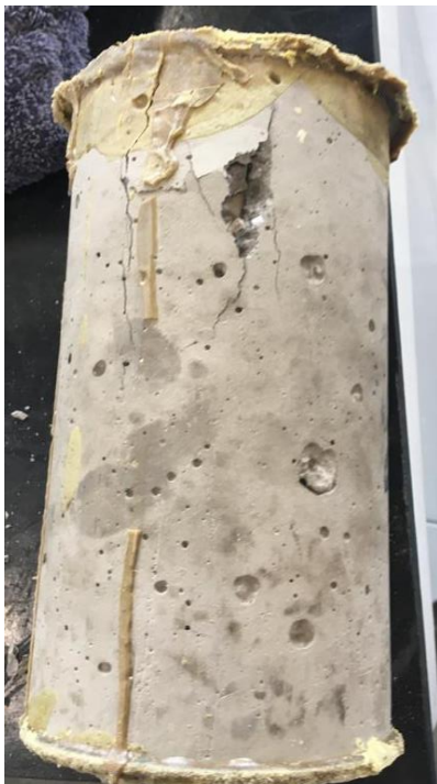
Imagen 22. Probeta fallada a compresión axial a los 28 días.
