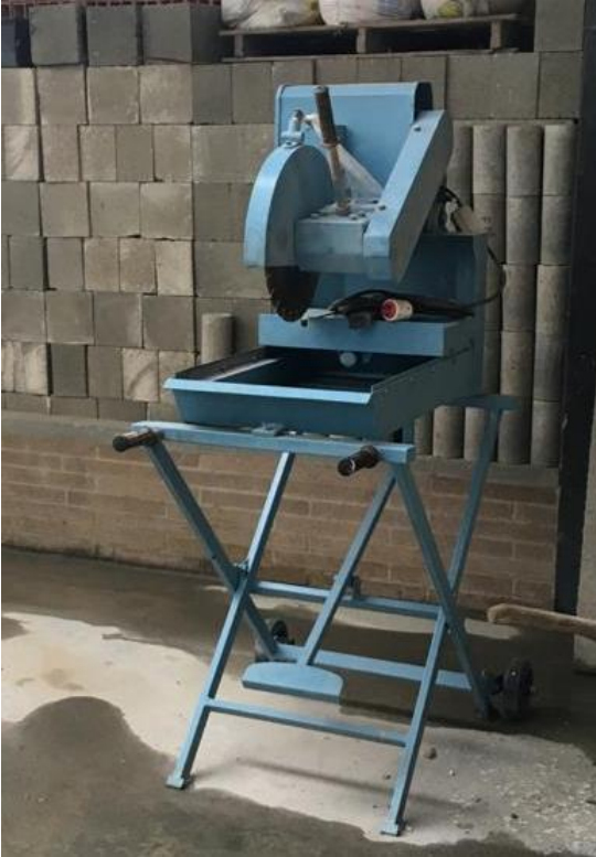
Imagen 36. Equipo para cortar las probetas en muestras de 5cm de espesor
