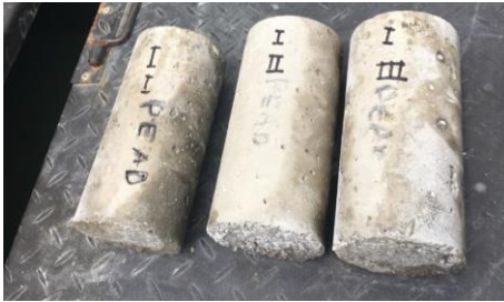
Imagen 6. Probetas para ensayo a compresión a los 7 días.
