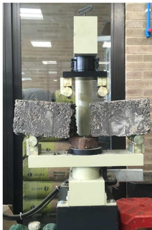
Imagen 26. Probeta fallada a flexión a los 28 días.
