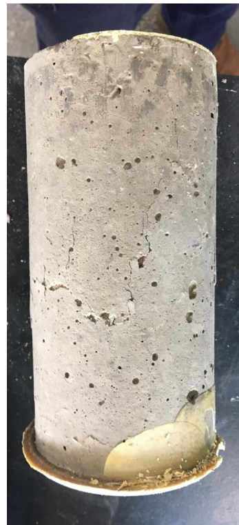
Imagen 21. Probeta fallada a compresión axial a los 28 días.
