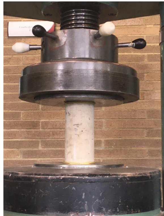
Imagen 11. Instalación de probetas en máquina de ensayo
