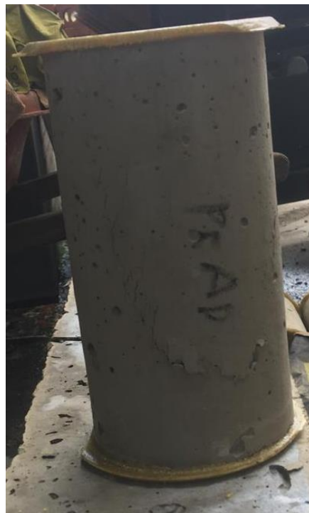
Imagen 23. Probeta fallada a compresión axial a los 28 días.
