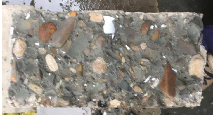
Imagen 35. Mezcla 4, plano de falla a tensión indirecta a los 28 días.
