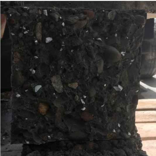
Imagen 29. Sección de falla mezcla 3
