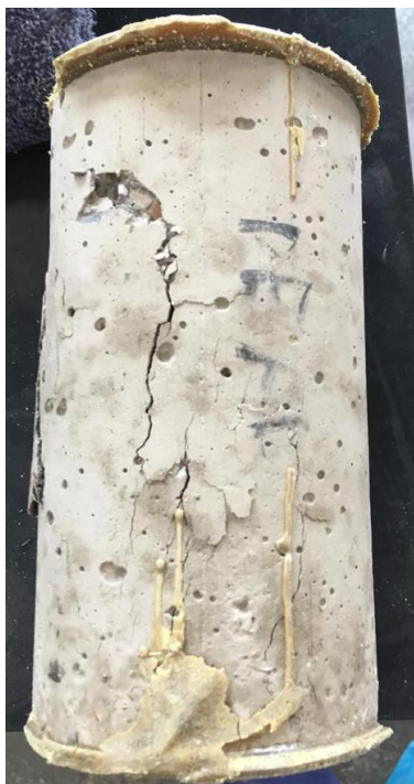
Imagen 18. Probeta fallada a compresión axial a los 14 días.
