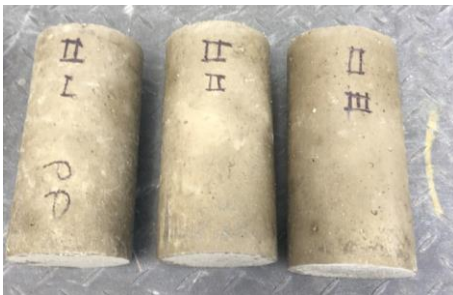
Imagen 7. Probetas para ensayo a compresión a los 14 días.
