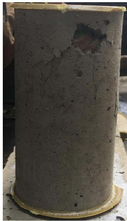
Imagen 19. Probeta fallada a compresión axial a los 14 días.
