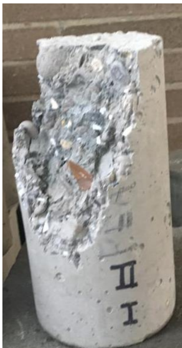
Imagen 14. Probeta fallada a compresión axial a los 7 días
