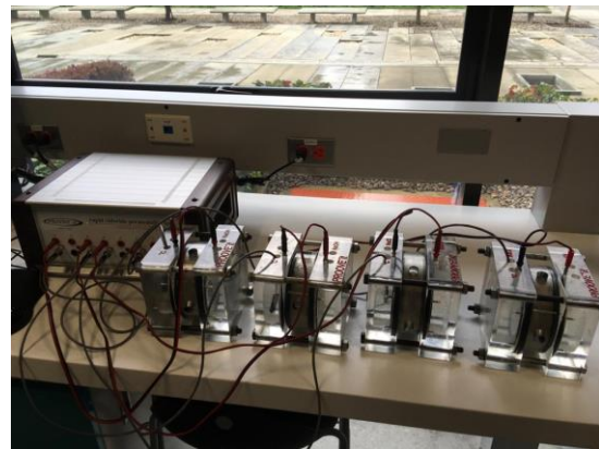
Imagen 38. Muestras durante ensayo de permeabilidad al ion cloruro
