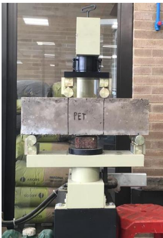
Imagen 25. Instalación de probetas en máquina de ensayo.
