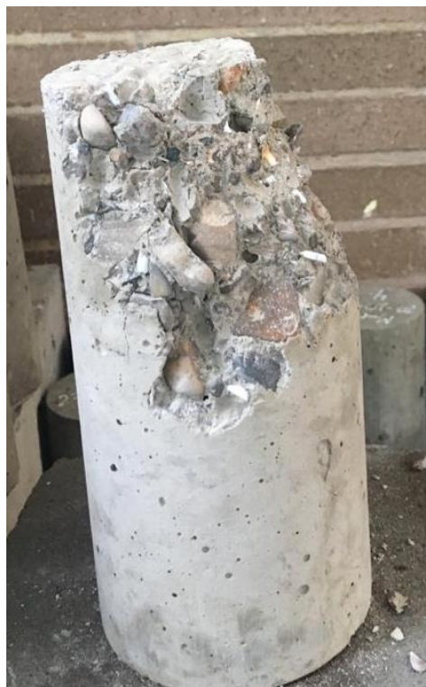
Imagen 13. Probeta fallada a compresión axial a los 7 días
