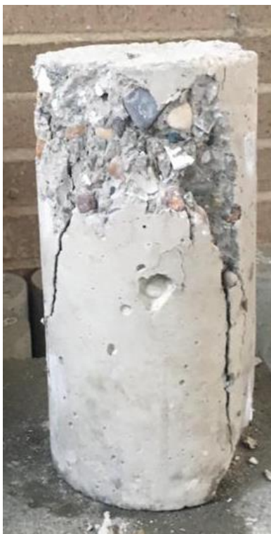
Imagen 12. Probeta fallada a compresión axial a los 7 días
