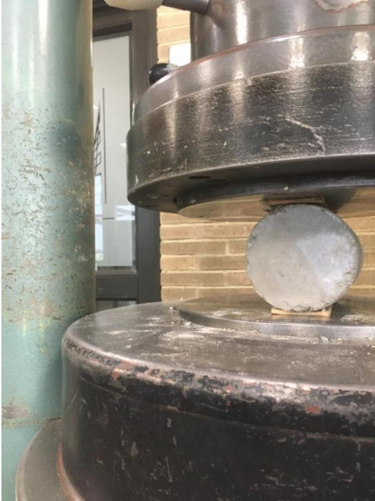
Imagen 31. Instalación de probetas en máquina de ensayo.
