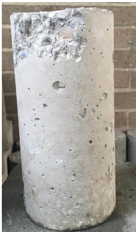
Imagen 17. Probeta fallada a compresión axial a los 14 días.
