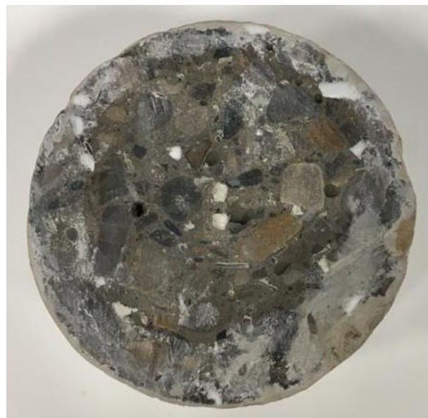
Imagen 46. Probeta de mezcla 4 después del ensayo.
