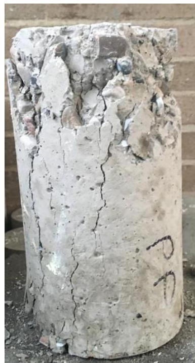
Imagen 15. Probeta fallada a compresión axial a los 7 días
