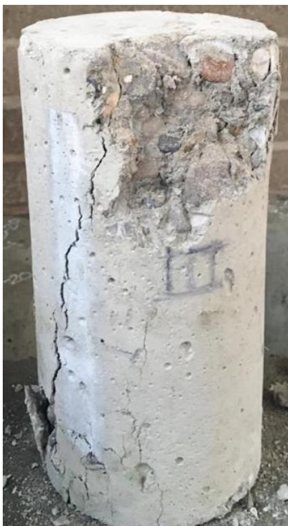
Imagen 16. Probeta fallada a compresión axial a los 14 días.
