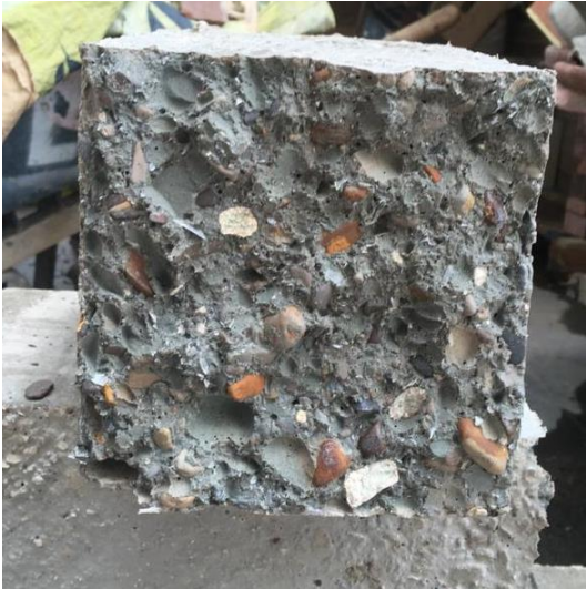
Imagen 27. Sección de falla mezcla 1
