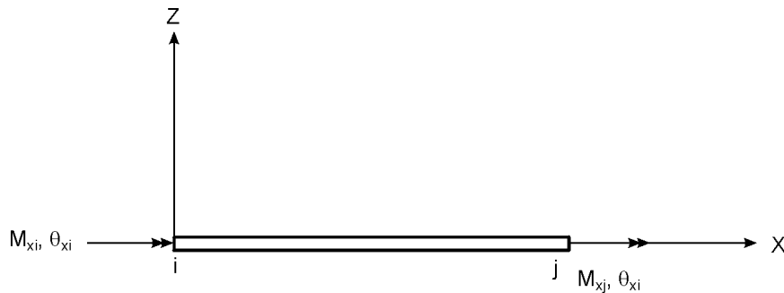
Figura 11.21 Representación esquemática de un elemento prismático sometido a torsión.
