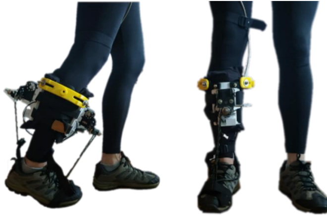
Figura 1.2: Dispositivo robótico T-FLEX [19]
