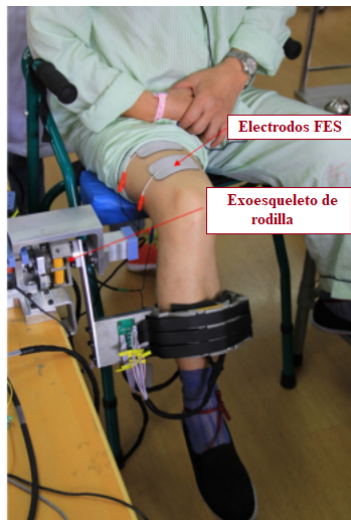
Figura 2.16: Sistema híbrido FES-exoesqueleto FEXO Knee [77]
