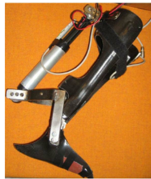
Figura 2.9: AFO desarrollado con un amortiguador MR [58].
