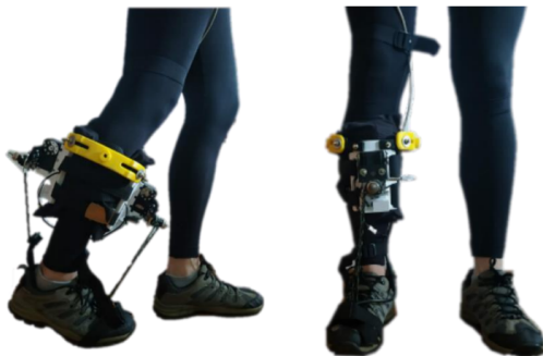
Figura 7.2: Usuario con Exoesqueleto de Tobillo T-FLEX.
