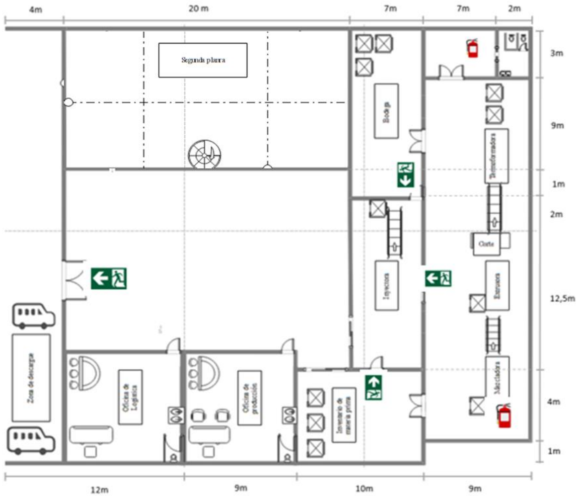
Ilustración 14 Plano del primer piso de la bodega
