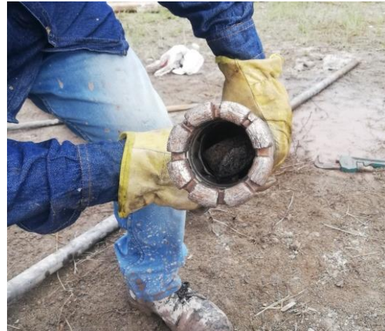
Imagen 58. Trabamiento de fragmento de roca en broca de concreción.
