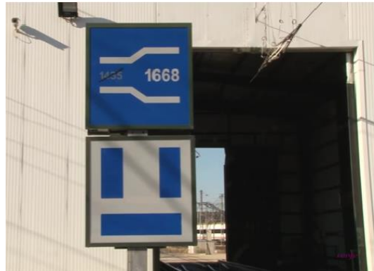
Imagen 16. Señalización de cambio de ancho de trocha de 1668mm a 1435mm en España.
