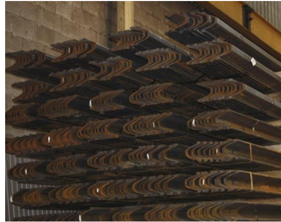
Imagen 95. Arcos cedentes en bodega.
