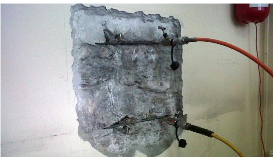
Imagen 84. Ejemplo de ensayo de gato plano.
