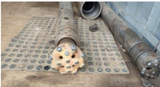
Imagen 57. Broca de alta presión de aire o brocas botón. Los botones son inserciones de carburo de tungsteno. Bogotá, Colombia.
