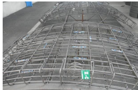
Ilustración 114. Instrumentación de segmentos con extensómetros VW
