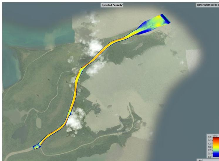
**Ilustración 120:** Velocidad de flujo en el tramo de estudio en dos dimensiones – día de velocidad intermedia.
