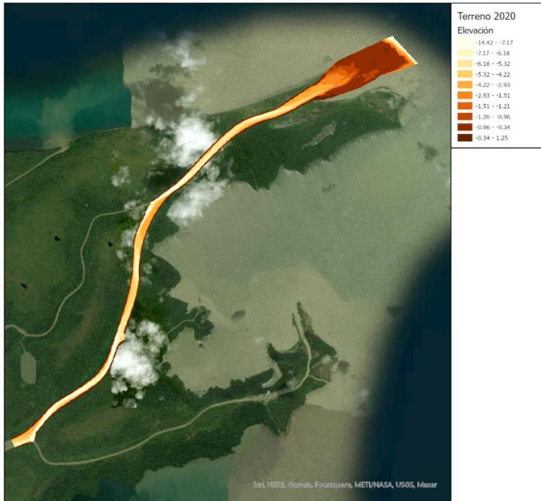
**Ilustración 133:** Terreno obtenido de HEC-RAS en septiembre de 2020, a partir de la modelación del transporte de sedimentos desde octubre de 2019.
