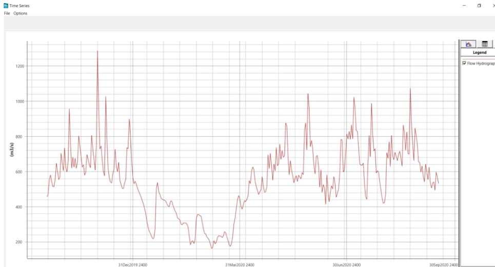
**Ilustración 118:** Hidrograma de entrada bajo condiciones de flujo no estacionario.
