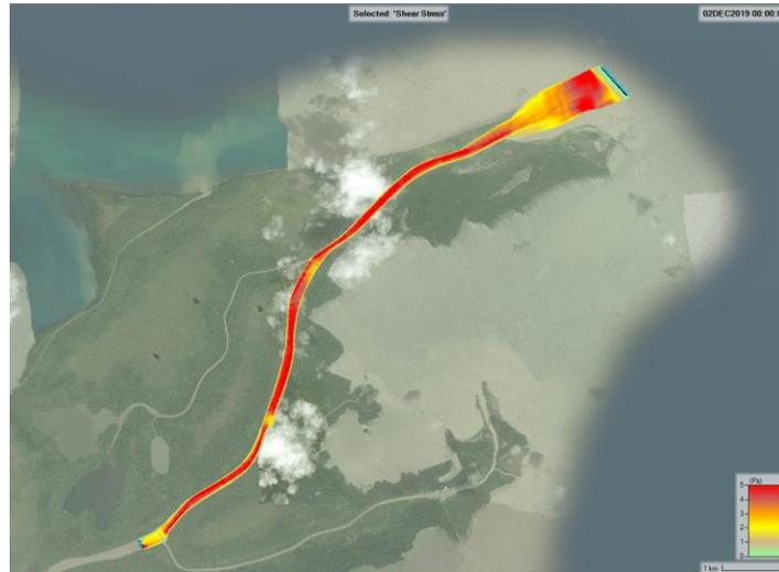
**Ilustración 127:** Esfuerzo cortante en el tramo de estudio en dos dimensiones – día de mayor esfuerzo cortante.
