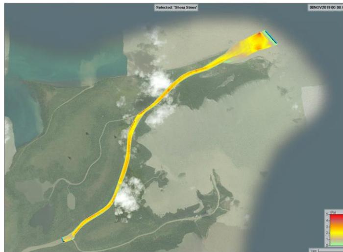
**Ilustración 126:** Esfuerzo cortante en el tramo de estudio en dos dimensiones – día de esfuerzo cortante intermedio.
