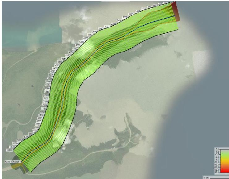
**Ilustración 96:** Generación de las secciones transversales en RAS Mapper.
