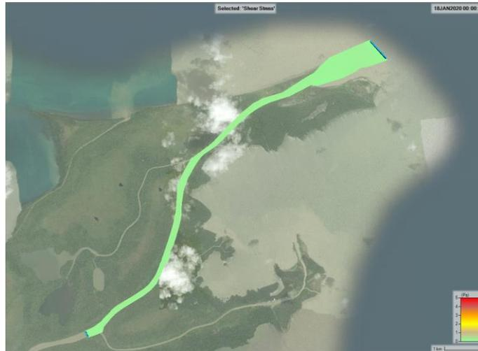
**Ilustración 125:** Esfuerzo cortante en el tramo de estudio en dos dimensiones – día de menor esfuerzo cortante.
