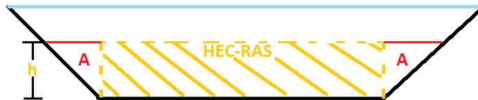
**Ilustración 48:** Esquema para determinar el área faltante a calcular, con el fin de calcular el volumen total a dragar para un canal trapezoidal.
