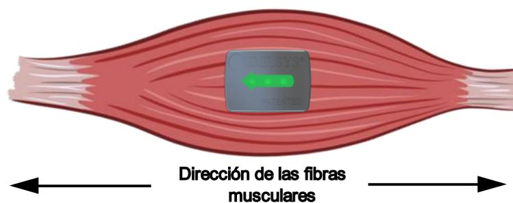
Figura 2. Orientación del sensor Trigno Advanti. Adaptado de [18].
