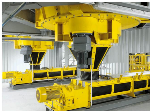
Ilustración 62. Parte inferior del reactor con mezcladora posterior de doble eje (masa, 2022)
