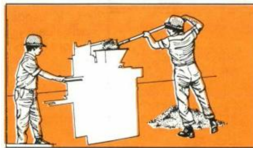
Ilustración 50. Vertimiento de la mezcla en la maquina (SENA, 1990)
