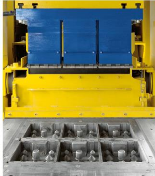
Ilustración 63. Mesa de prensado con inserto de molde intercambiable (masa, 2022)
