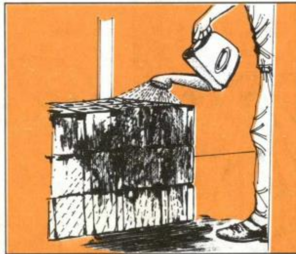
Ilustración 57. Curado de bloque de concreto (SENA, 1990)
