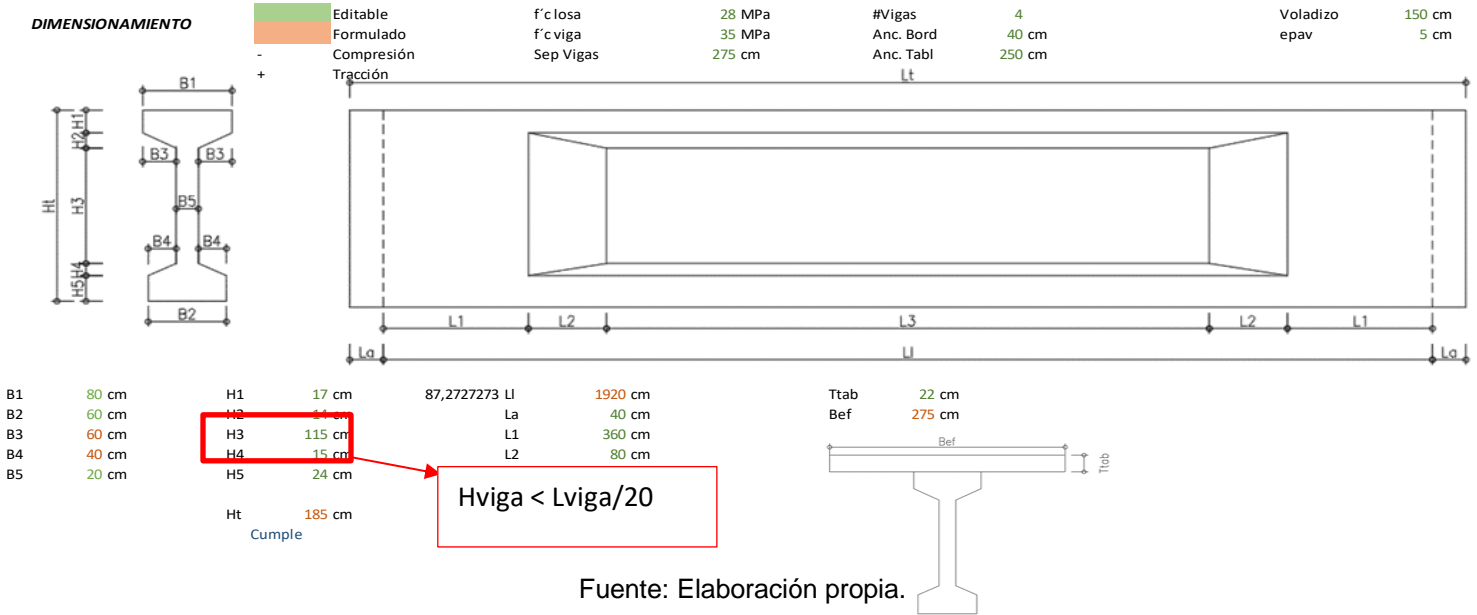
Ilustración 25 Definición geométrica de vigas
