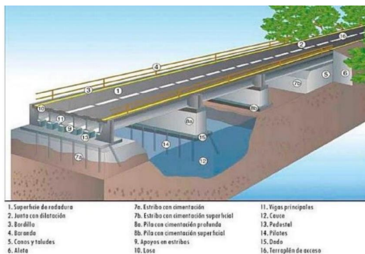
Ilustración 21 Componentes típicos de los puentes.
