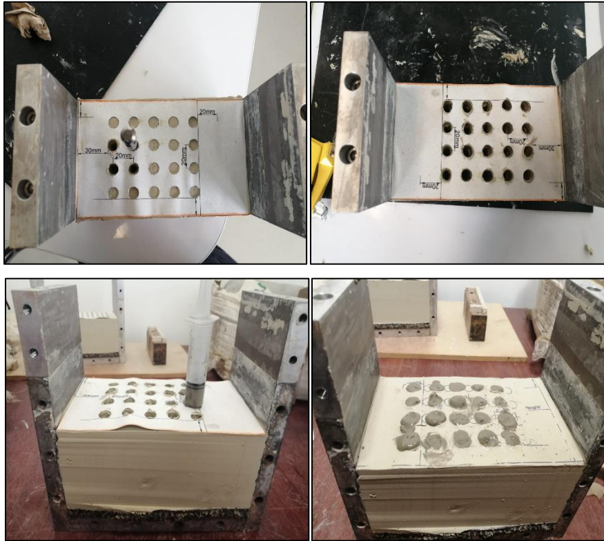
Figura 49. Perforación y construcción de columnas de suelo cemento de 1.0 m de diámetro, S=2D Fuente: elaboración propia
