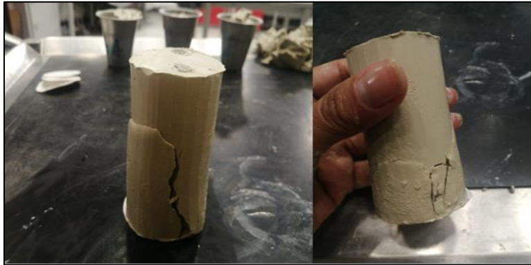
Figura 35. Ensayo de resistencia a la compresión inconfiada de muestra M1 con separación S= 4D Fuente: elaboración propia
