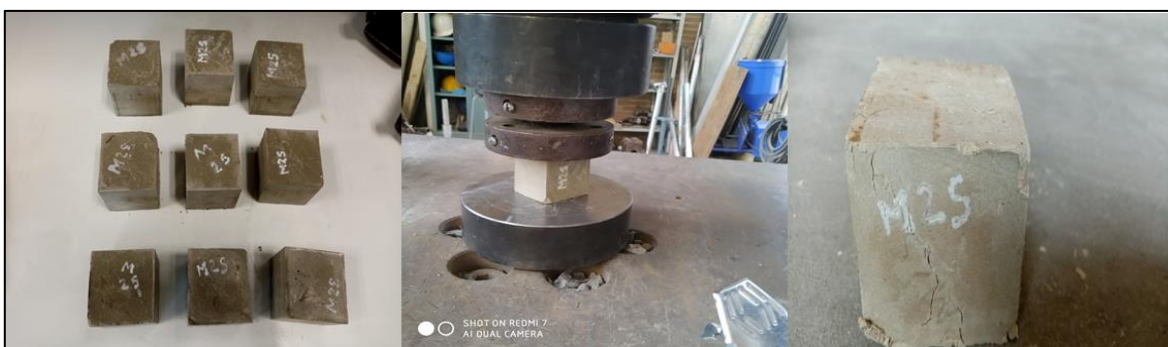
Figura 26. Ensayo de resistencia a la compresión a los siete días para la mezcla N°2 de suelo cemento Fuente: elaboración propia
