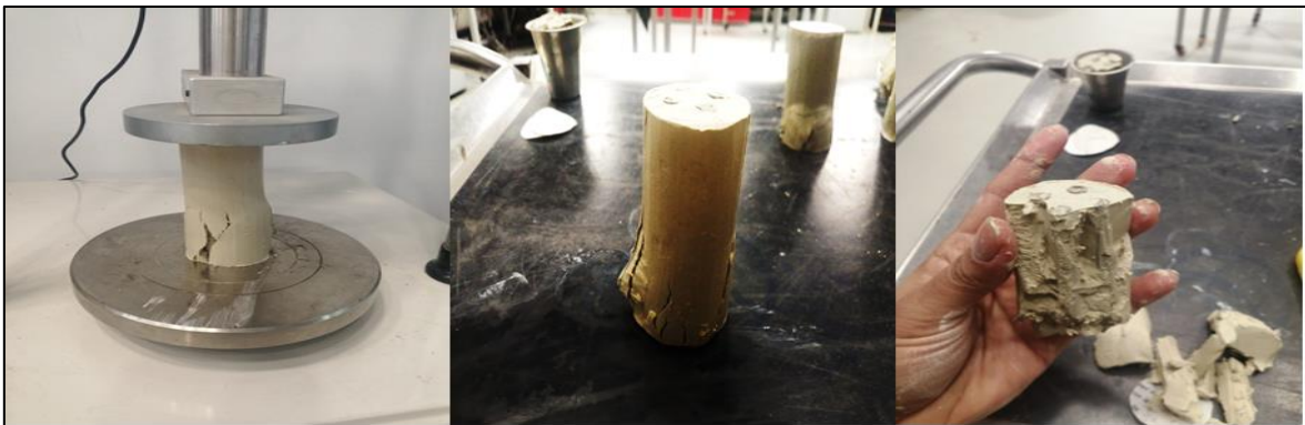
Figura 33. Ensayo de resistencia a la compresión inconfiada de muestra M2 con separación S= 2D Fuente: elaboración propia
