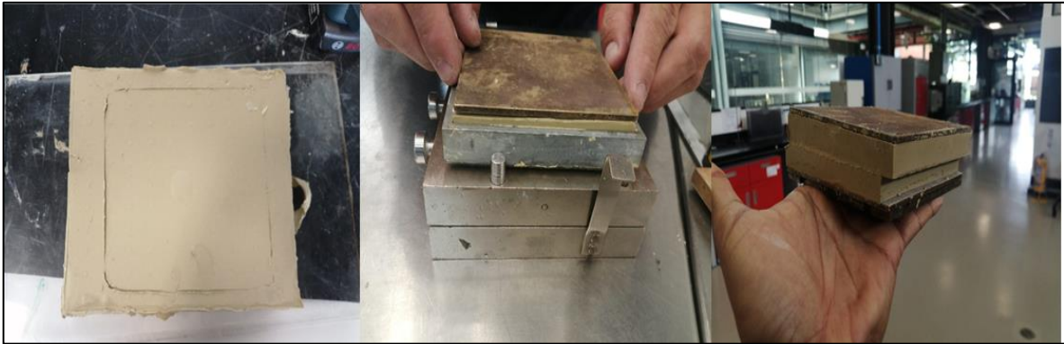
Figura 28. Ensayo de corte directo, CD, para muestra M1 con un esfuerzo vertical de 80 kPa Fuente: elaboración propia
