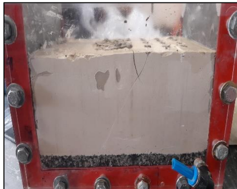
Figura 65. Inicio de curado de las columnas de suelo cemento con D= 0.6m , S= 3D distribuidas en el cuerpo del terraplén y pantallas en el talud. Fuente: elaboración propia
