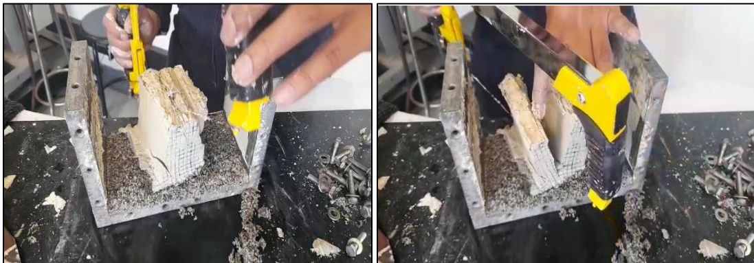
Figura 51. Auscultación de columnas de suelo cemento de D= 1.0m y S= 2D
