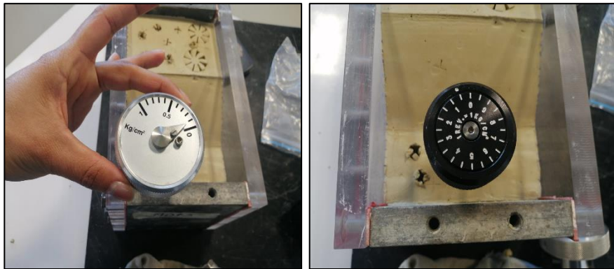
Figura 56. Ensayo de resistencia al corte no drenado con miniveleta sobre el suelo de fundación sin mejora en el área de berma del modelo con D=0.6\text{m} y S= 3D . Fuente: elaboración propia
