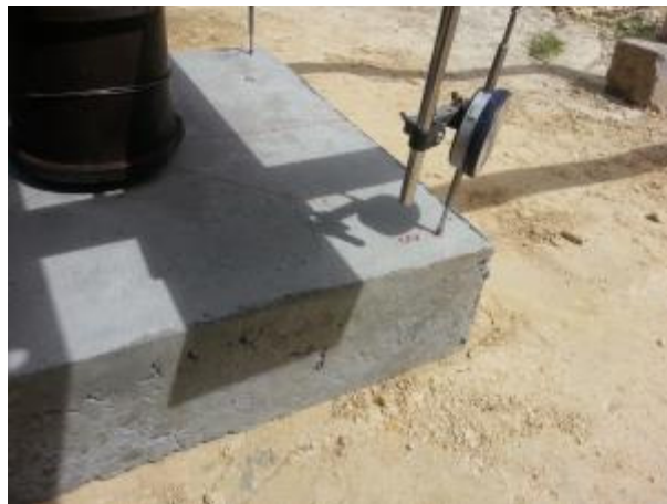
Figura 2.1. Zapata 1 durante la prueba de carga
