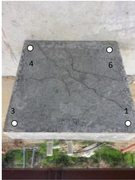
Figura 5.11. Fisuras en la zapata 3
