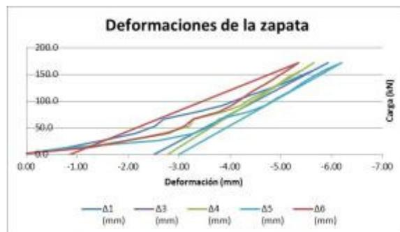
Figura 5.4. Curva carga versus deformación zapata 2 (con carga y con descarga)
