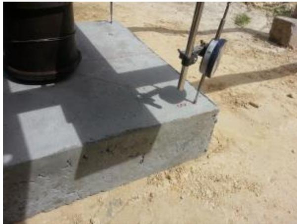
Figura 4.2. Zapata 1 durante la prueba de carga
