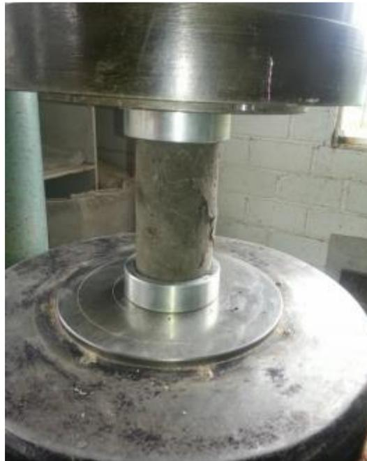
Figura 9.2. Falla de un cilindro del primer diseño de mezcla
