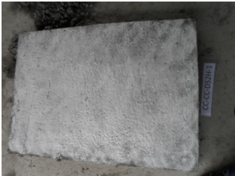
Fotografía 3.11 Con curado con compuesto curador desecación superficial+ 2 h
