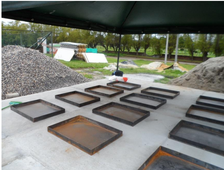
Fotografía 4.5 Disposición de muestras con compuesto curador.
