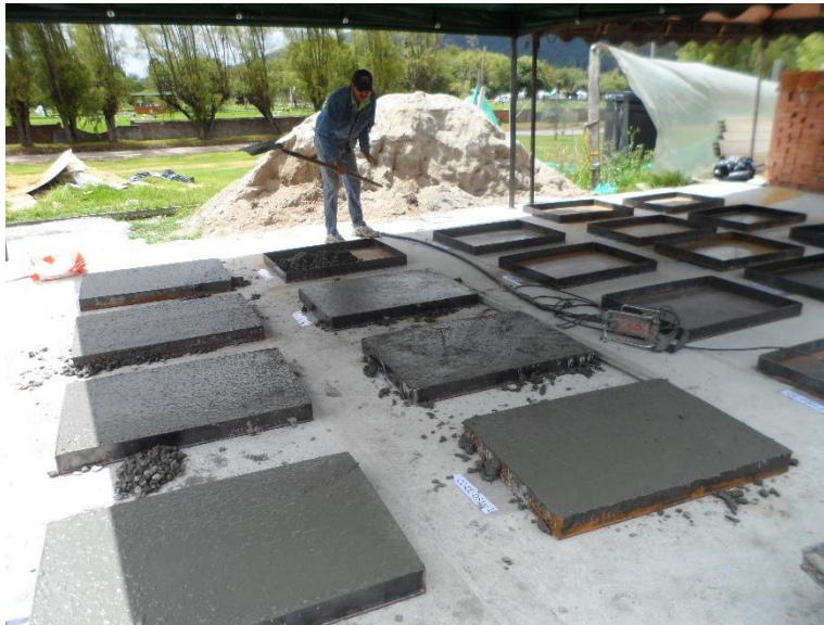
Fotografía 4.6 Disposición de muestras con compuesto curado y efecto de los rayos solares.
