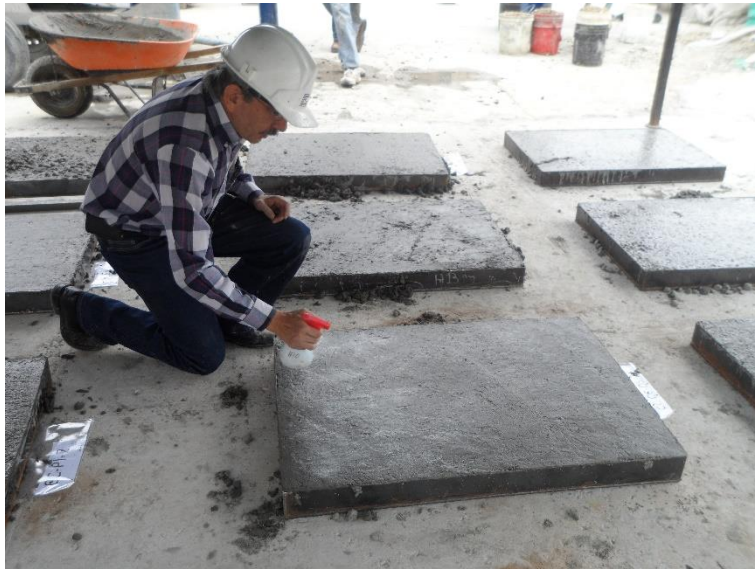
Fotografía 3.10 Con curado con compuesto curador desecación superficial+ 1 h
