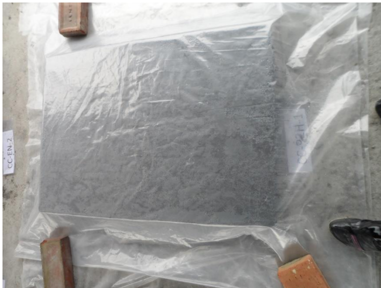
Fotografía 3.6 Con curado, recubrimiento con plástico 2 horas después.
