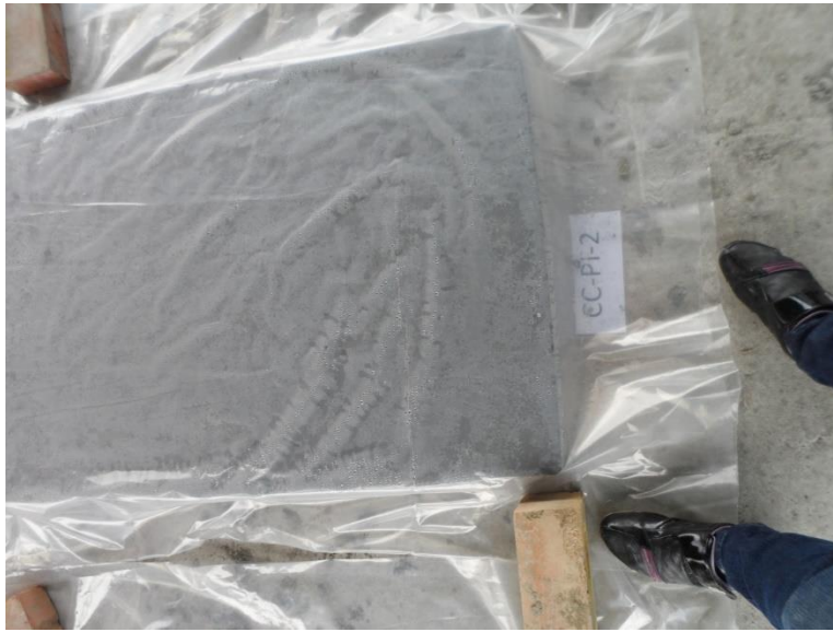
Fotografía 3.5 Con curado, recubrimiento con plástico inmediatamente.
