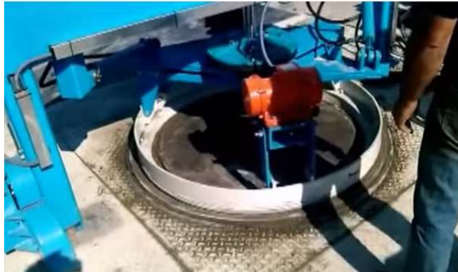
Figura 29 Compactación de prensa vibrocompactadora Fuente. https://www.youtube.com/watch?v=3b2e4FizRUg
