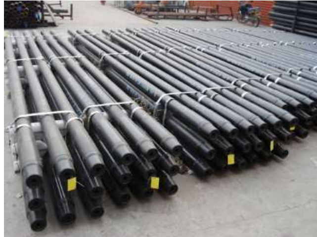
Figura 10 Varillaje para perforación horizontal dirigida Fuente http://www.geocoredrill.com/es/HDD-Reamer-products.html
