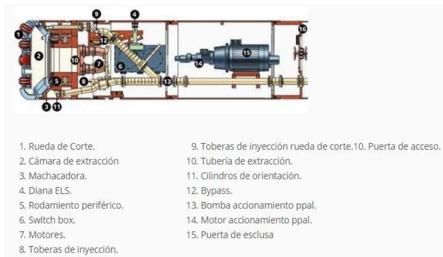
Figura 24 Microtuneladora de presión de lodos (AVN)
