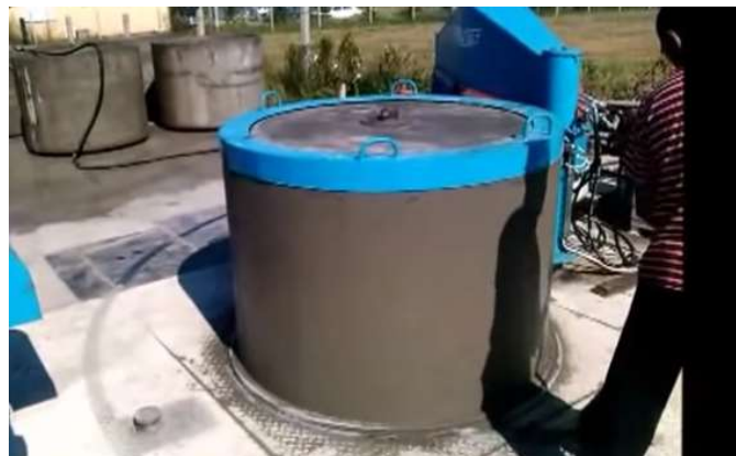
Figura 30 Retiro de la tubería de prensa vibrocompactadora Fuente. https://www.youtube.com/watch?v=3b2e4FizRUg
