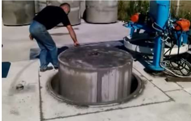
Figura 27 Equipo de prensa vibrocompactadora Fuente. https://www.youtube.com/watch?v=3b2e4FizRUg
