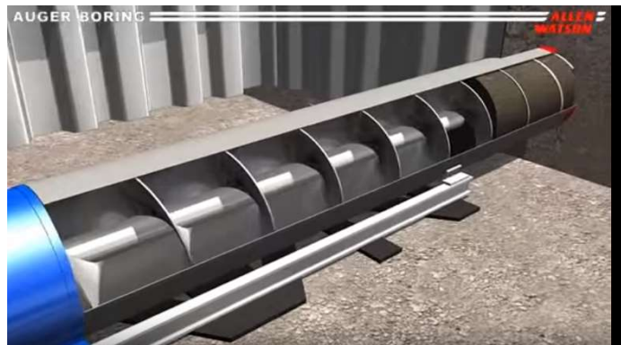
Figura 18 Sistema de camisa de acero con tornillo sinfín en su interior (Auger Boring) Fuente. http://www.perfocolingenieria.com/auger-boring
