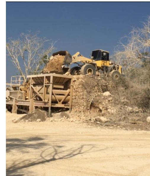
Trituración del material extraído para obtener base y sub base Trituradora No. 2
