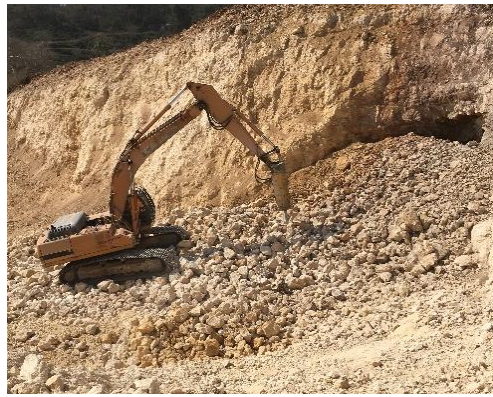
Extracción de piedra caliza por medio de martillo
