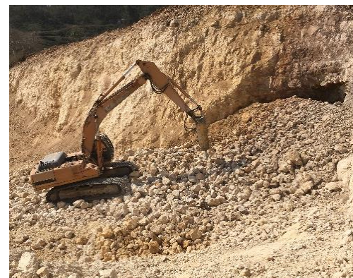
Extracción de piedra caliza por medio de martillo
