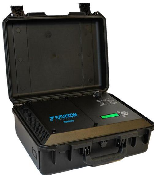
**Figura 25. Repetidor portátil P-25 PDR 8000 [58]**
