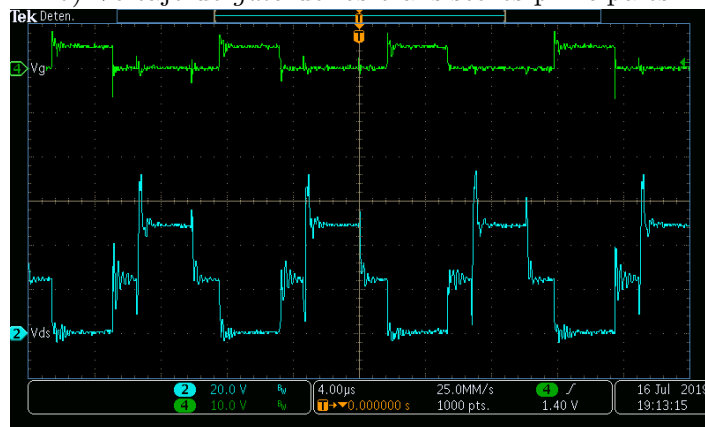
c) Voltaje de drain y source junto al voltaje de gate de uno de los transistores principales
