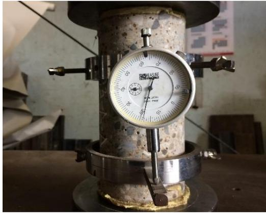
Ilustración 3-23 Compresómetro para ensayo de módulo de elasticidad
