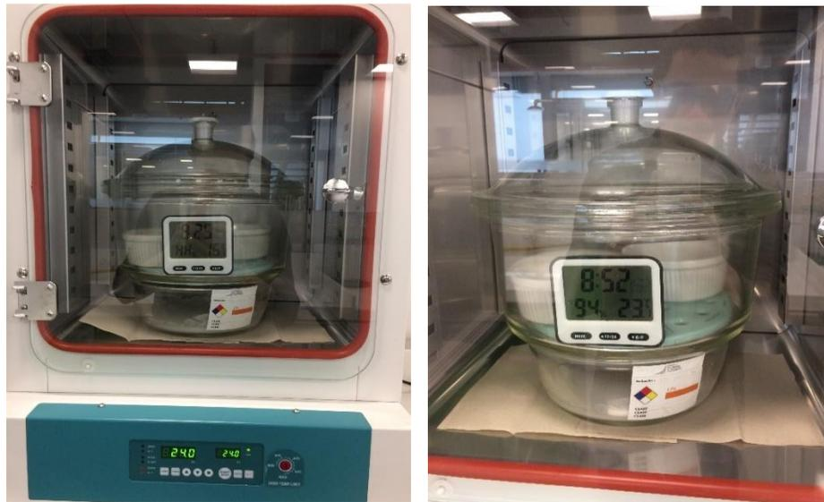
*Ilustración 3-8 Temperatura y HR controlada del ensayo de desorción*
