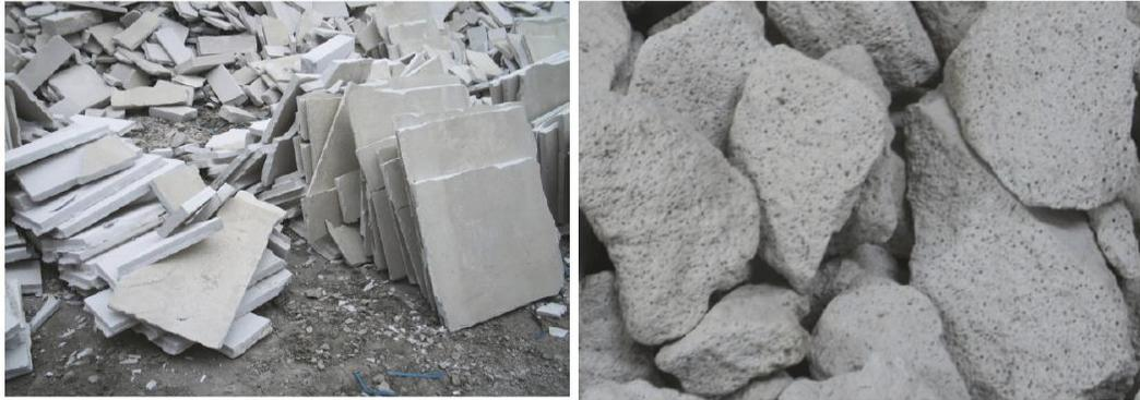
Ilustración 1-21 LWA a base de concreto aireado en autoclave reciclado
