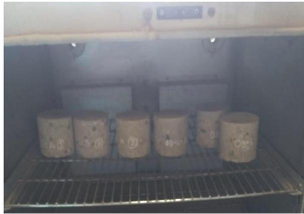
*Ilustración 3-26 Muestras secadas al horno NTC 5653*
