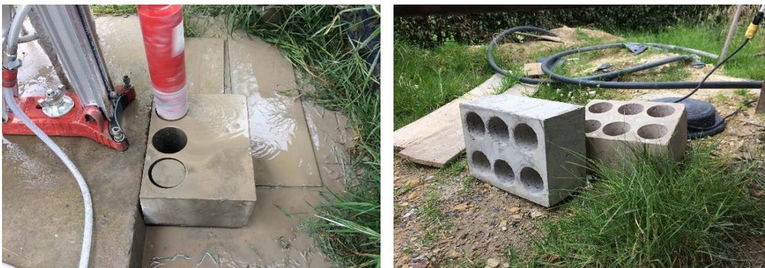
Ilustración 3-17 Extracción de los núcleos de concreto
