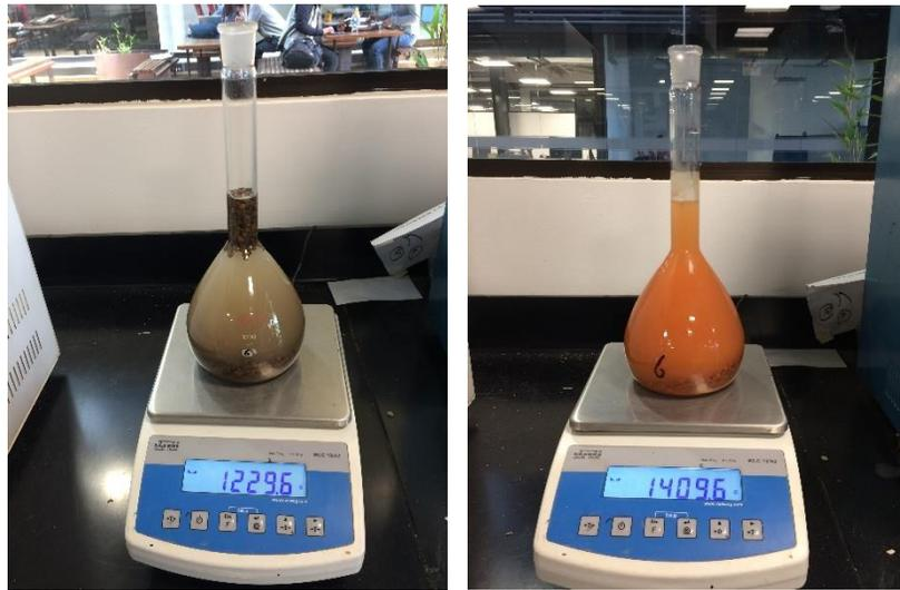
Ilustración 3-4 Ensayo de absorción según ASTM 1671
