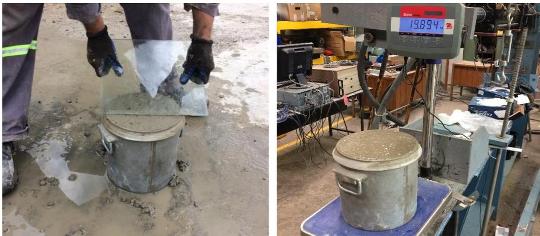
Ilustración 4-3 Masa unitaria y contenido de aire del concreto
