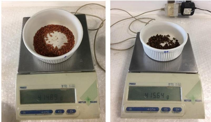
*Ilustración 3-6 Ensayo de desorción según ASTM 1671.*
