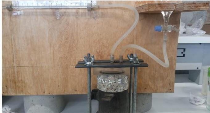
*Ilustración 3-24 Montaje para ensayo ISAT*
