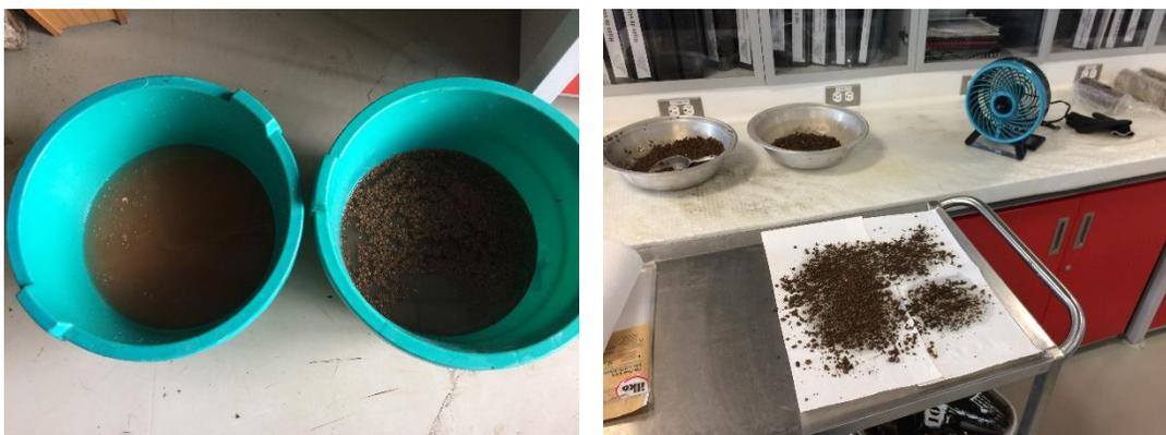
*Ilustración 3-2 Saturación y ensayo de SSS de los LWAs*
