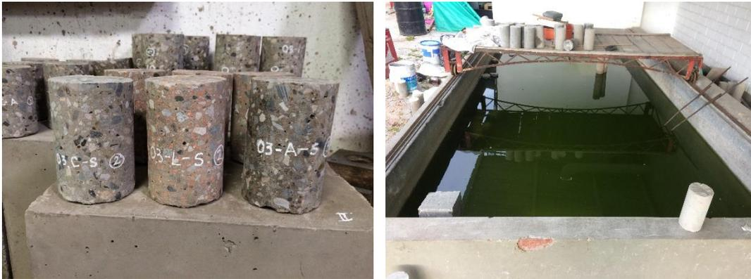
*Ilustración 3-19 Ambientes de curado de losas*
