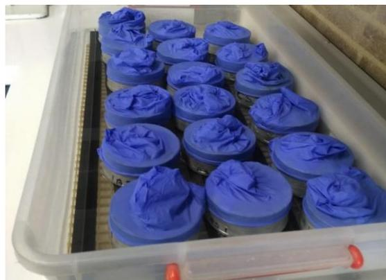
*Ilustración 3-25 Ensayo de sorptividad*
