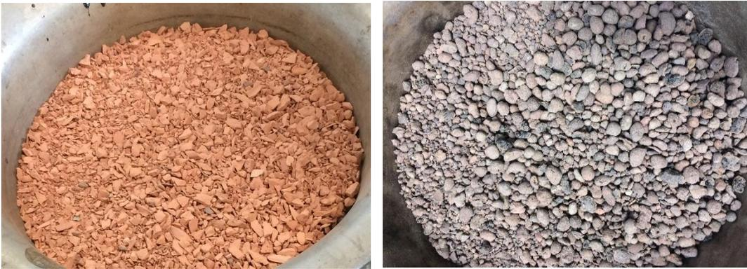
Ilustración 3-1 Derecha Ladrillo triturado. Izquierda Arcilla expandida térmicamente
