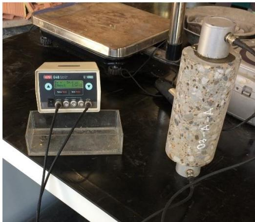
*Ilustración 3-21 Ensayo de velocidad de pulso*
