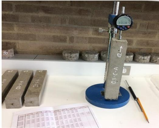
Ilustración 3-27 Ensayo de variación volumétrica
