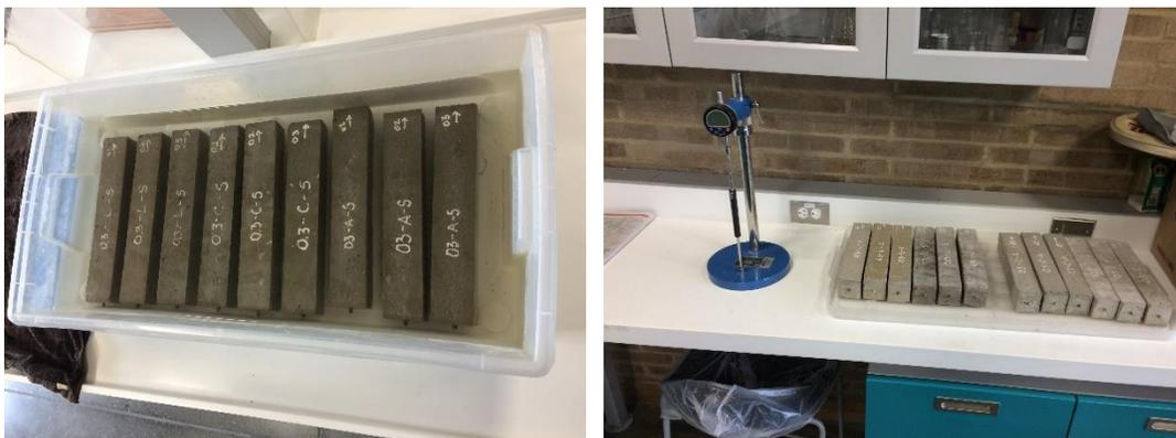
*Ilustración 3-20 ambientes de curado de vigas*
