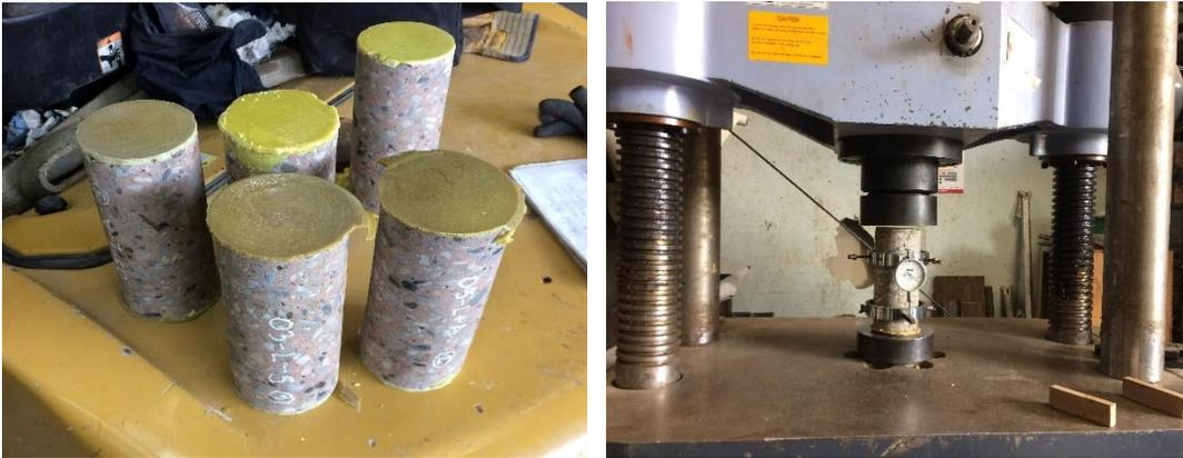
*Ilustración 3-22 Especímenes de ensayo a compresión*
