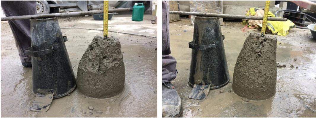
*Ilustración 4-2 Slump. Concreto estándar (izquierda) y concreto con LWA (derecha)*
