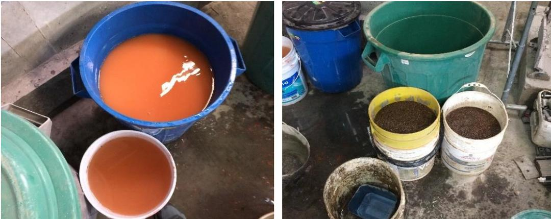
Ilustración 3-14 Saturación de los agregados ligeros
