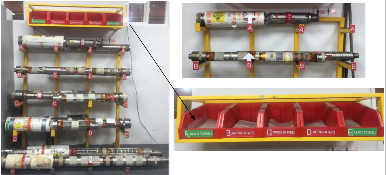
Figura 3-22. Foto izquierda, almacenamiento de materiales que necesitan inventario. Foto derecha, estantes donde se encuentra el detalle de materiales requerido para cada sensor.
