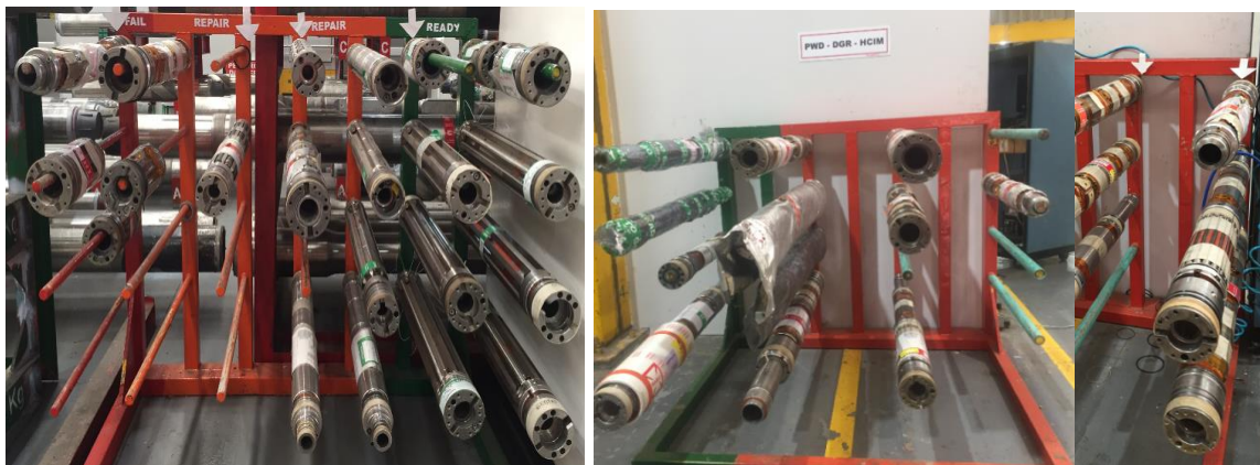
Figura 3-12. Fotos de asignación de sensores en Racks clasificados por los colores estándar
