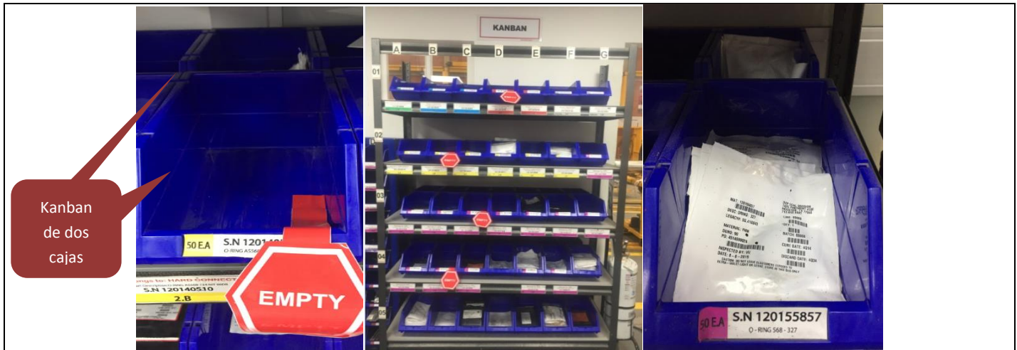
Figura 3-18. Fotos donde se observa el almacenamiento del inventario y el diseño del Kanban de dos cajas en el área de inspección. Las etiquetas rojas muestran los materiales que NO tienen stock.
