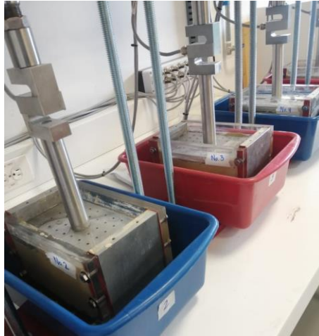
Figura No. 15 - Muestras consolidándose en el laboratorio de suelos ECI. Fuente: Elaboración propia.
