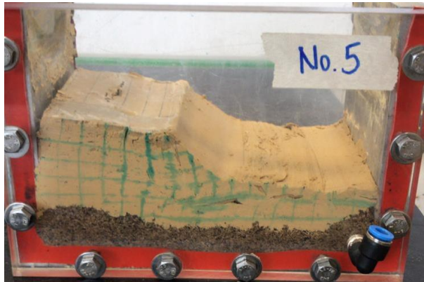
Figura No. 23 - Modelo 1 luego del ensayo, sin alternativa de estabilización. Fuente: Elaboración propia.
