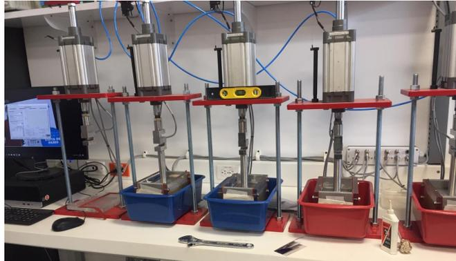
Figura 5 Consolidómetros edométricos
