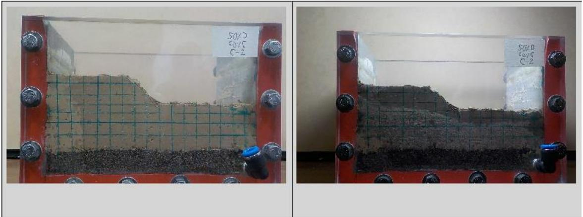
Figura 11 Modelo 50C-50D de Centrifuga entes y después del vuelo
