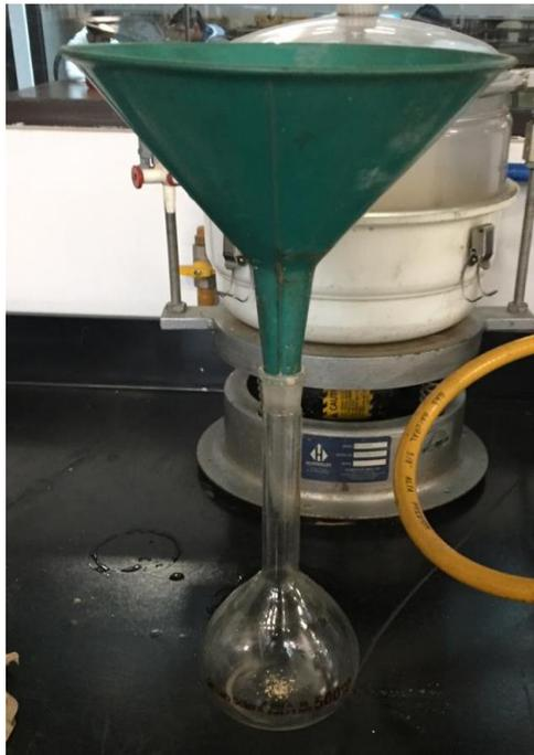
Figura 52 Picnómetro con embudo para echar el agua y el suelo
