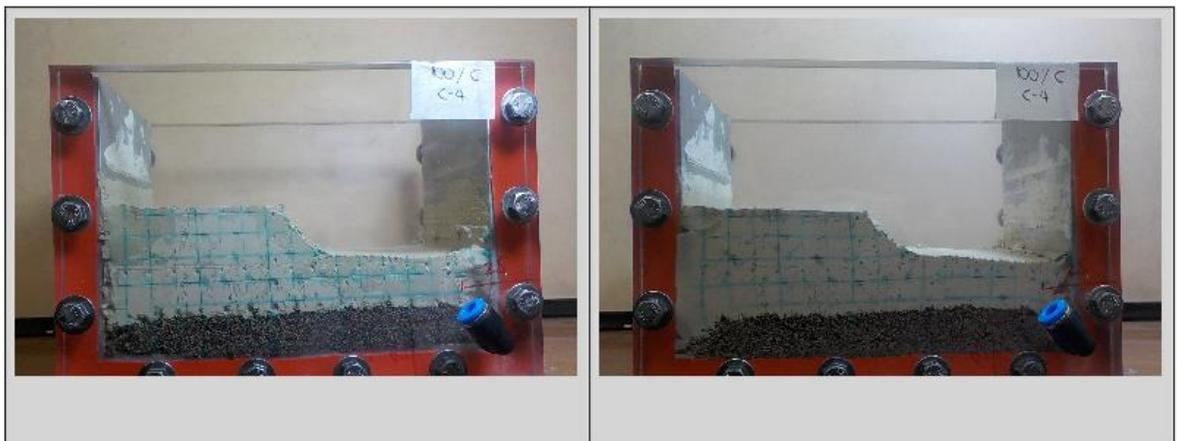
**Figura 7 Modelo 100C-0D antes y después del vuelo.**
