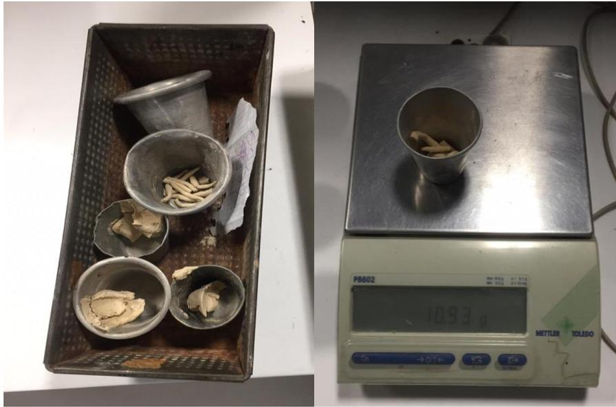
**Figura 29 Muestras luego de secar al horno y pesar en bascula**
