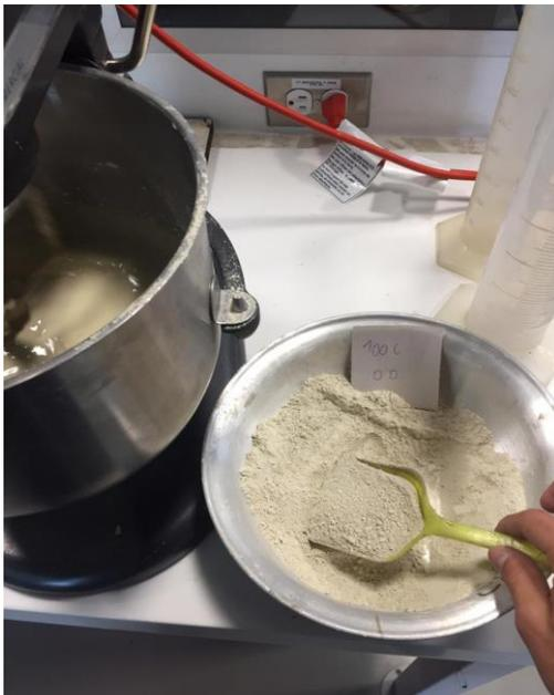
**Figura 41 forma de echar el material en la mezcladora**
