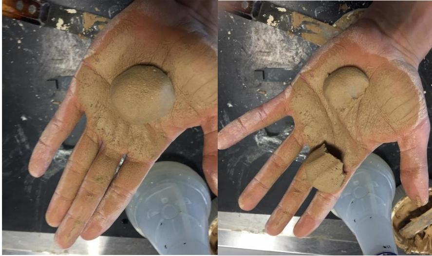
**Figura 27** Proceso para realizar los limites plásticos
