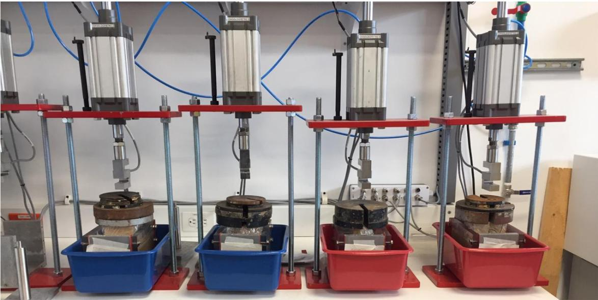
**Figura 48** Cajas de consolidación con 7.5 kg de carga
