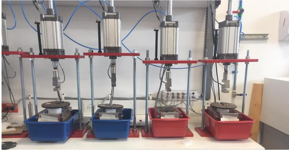
**Figura 46** caja de consolidación con 1 kg de carga
