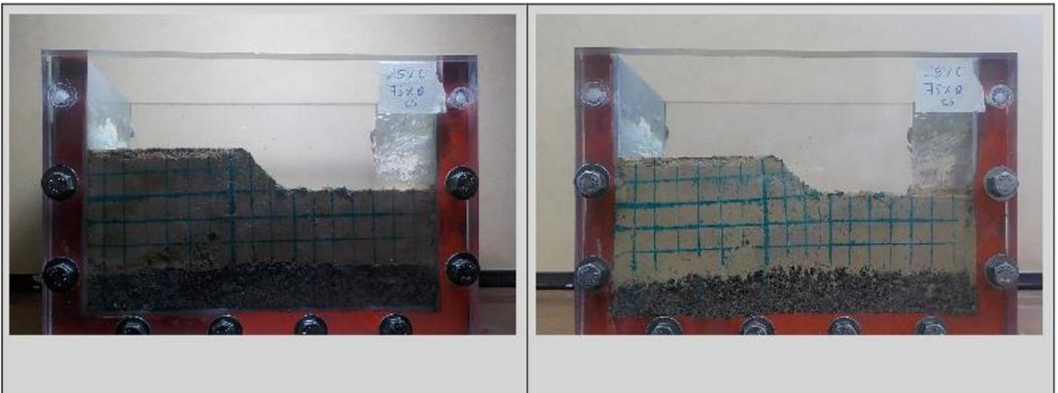
Figura 13 Modelo 25C-75D de Centrifuga entes y después del vuelo
