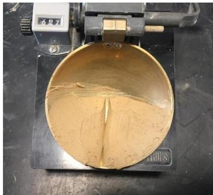
Figura 26 Cazuela de Casagrande después de dar los golpes necesarios para cerrar la línea
