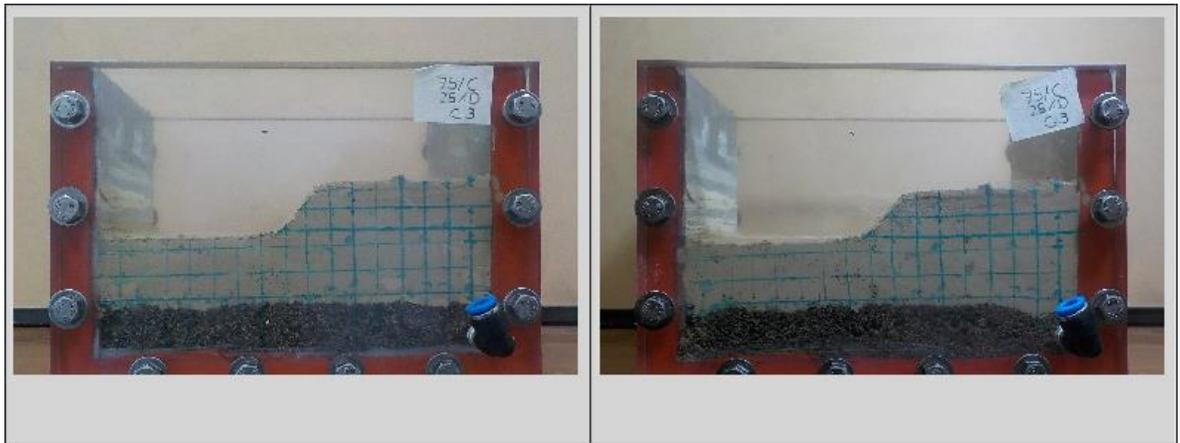
Figura 9 Modelo 75C-25D de Centrifuga antes y después del vuelo
