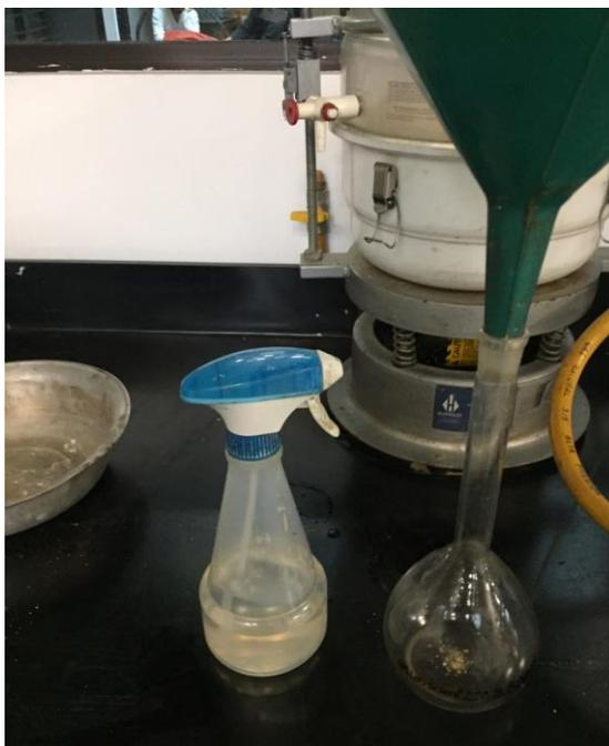
**Figura 55 Picnómetro, atomizador y embudo**
