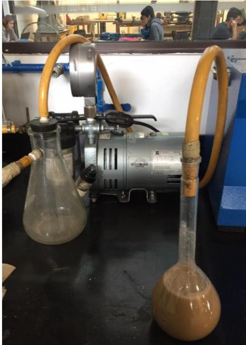
**Figura 53** Picnómetro con el material listo para bombear y sacar el aire
