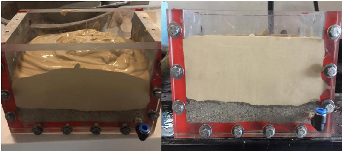
**Figura 43 Mezcla lista vertida en las cajas de los Consolidómetros**
