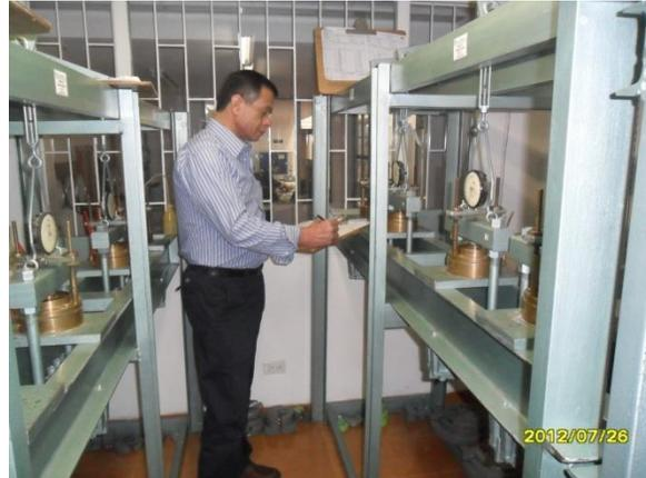
**Fotografía 5. Consolidómetros de Suelos y Pavimentos Gregorio Rojas & Cía Ltda.**
