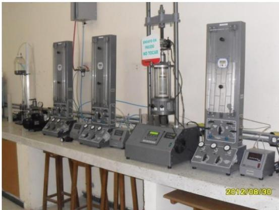
**Fotografía 2. Proceso de falla de muestra 4 en equipo triaxial de UNIAGRARIA**
