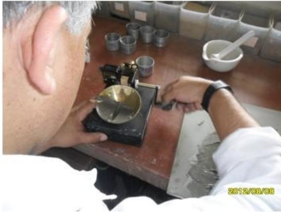
**Fotografía 7. DMS realizando ensayo de LL**
