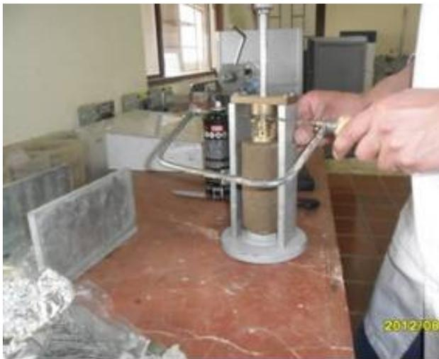
**Fotografía 8. Proceso de tallado de muestra para ensayo Triaxial UU**
