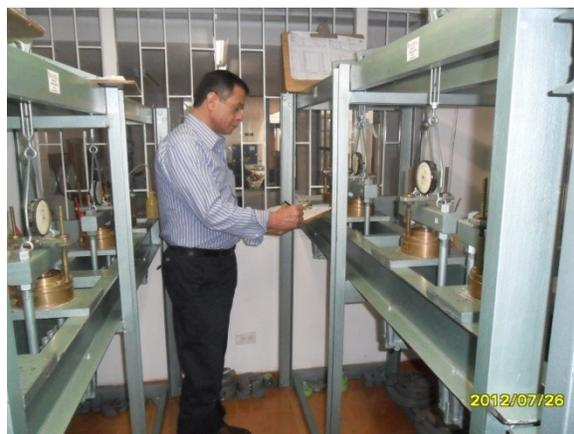
**Fotografía 15. Consolidómetros de Suelos y Pavimentos Gregorio Rojas & Cía Ltda.**
