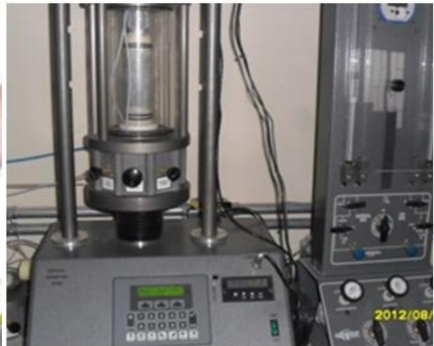
**Fotografía 9. Proceso de falla en cámara triaxial**
