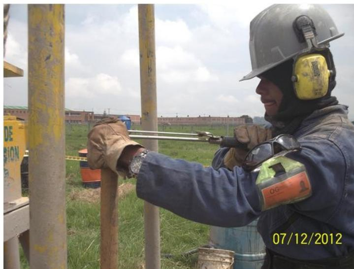
Fotografía 5. Toma de lectura de momento de giro T en el ensayo con veleta
