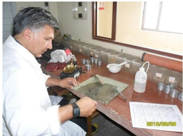
**Fotografía 6. DMS Preparación de suelo para ensayo de Límites**
