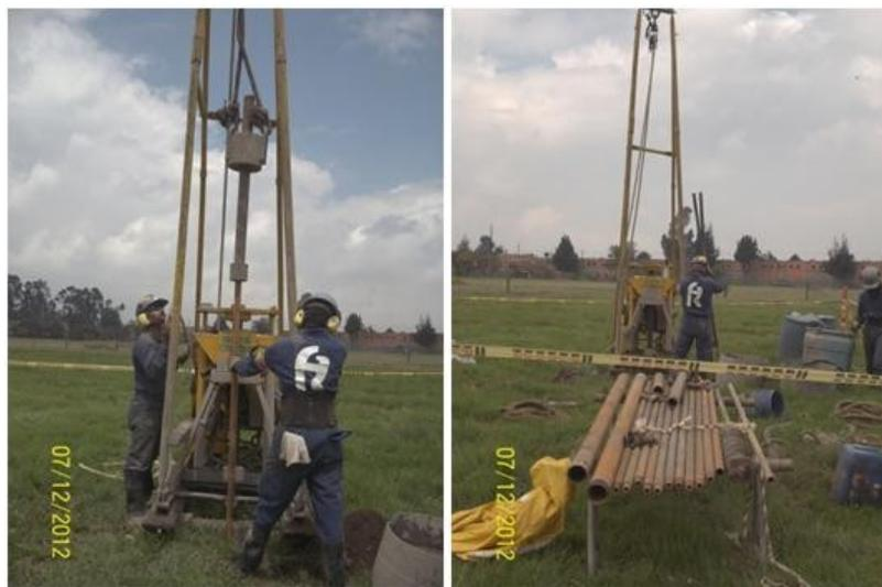
Fotografía 1. Equipo mecánico de percusión y lavado
