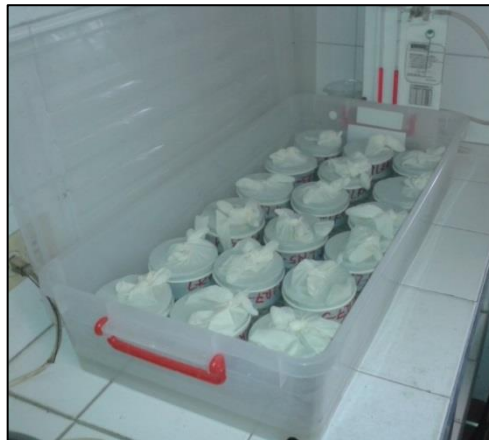
Figura 3-13: Montaje del ensayo de sortividad
