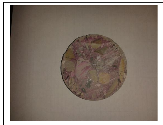
Figura 3-12: Fotografía ensayo de carbonatación sobre espécimen de la muestra ACR2-25.
