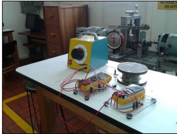
Figura 3-14: Montaje de ensayo de resistividad según norma UNE 83988-1
