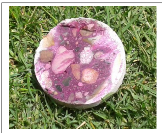
Figura 3-12: Fotografía ensayo de carbonatación sobre espécimen de la muestra ACR2-25.
