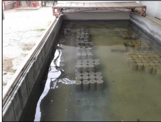
Figura 3-3: Curado de especímenes de concreto
