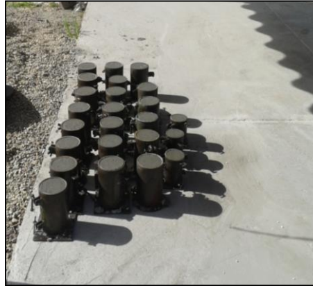
Figura 3-5: Probetas obtenidas para la mezcla AN5-0 (0%ACR - A/C=0,6)
