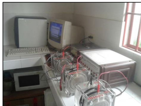
Figura 3-10: Montaje de ensayo de permeabilidad al ion cloruro
