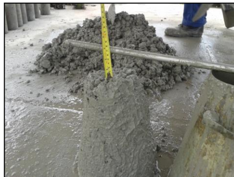
Figura 3-6: Ensayo de asentamiento en la mezcla AN5-0
