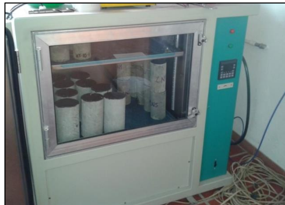
Figura 3-11: Cilindros de concreto de 75mm x 150 mm en cámara de carbonatación
