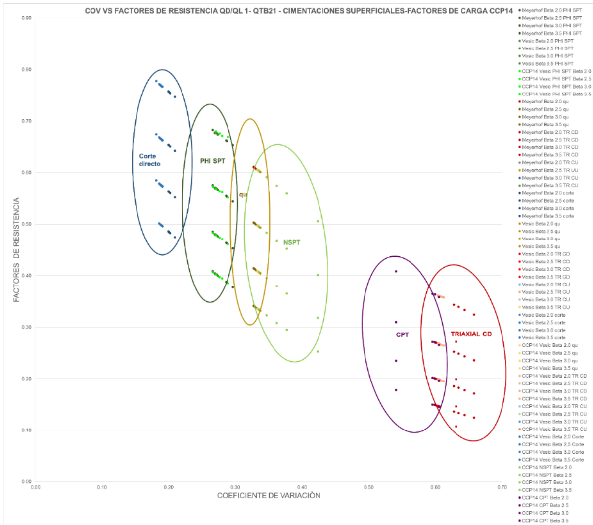
Figura 53 Factores de resistencia vs COV QD/QL 1 – QTB21-Cimentaciones superficiales- Factores de carga CCP14
