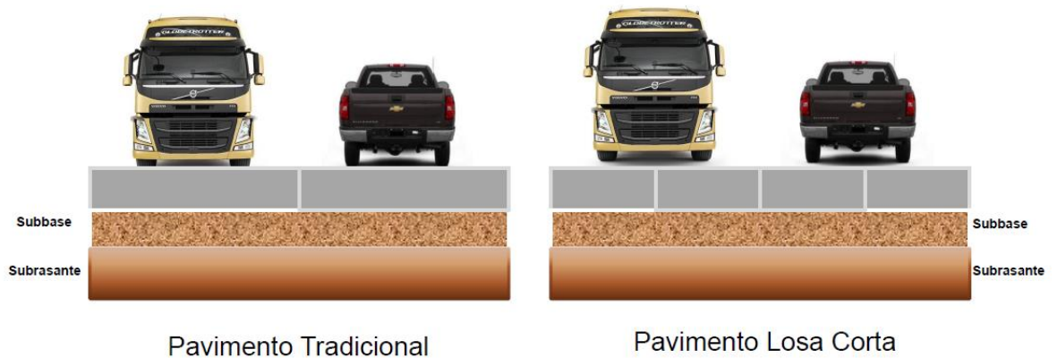
Figura 11: Comparación en perfil de las losas tradicionales respecto de la losa corta. Fuente:(Mauricio Salgado Torres, 2014)
