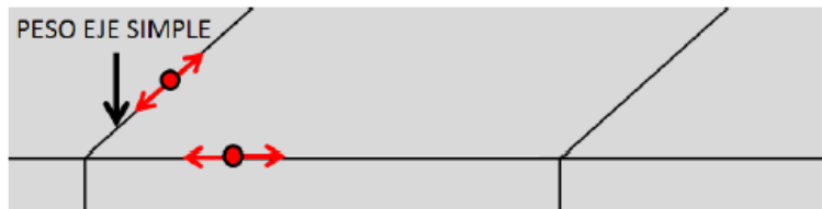
Figura 25. Ubicación del Eje Simple para determinar el agrietamiento de esquina. Fuente: (Covarrubias, 2011)
