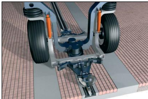
Figura 5-7. Imagen digital de un bogie Translohr Fuente: (Translohr, 2013)
