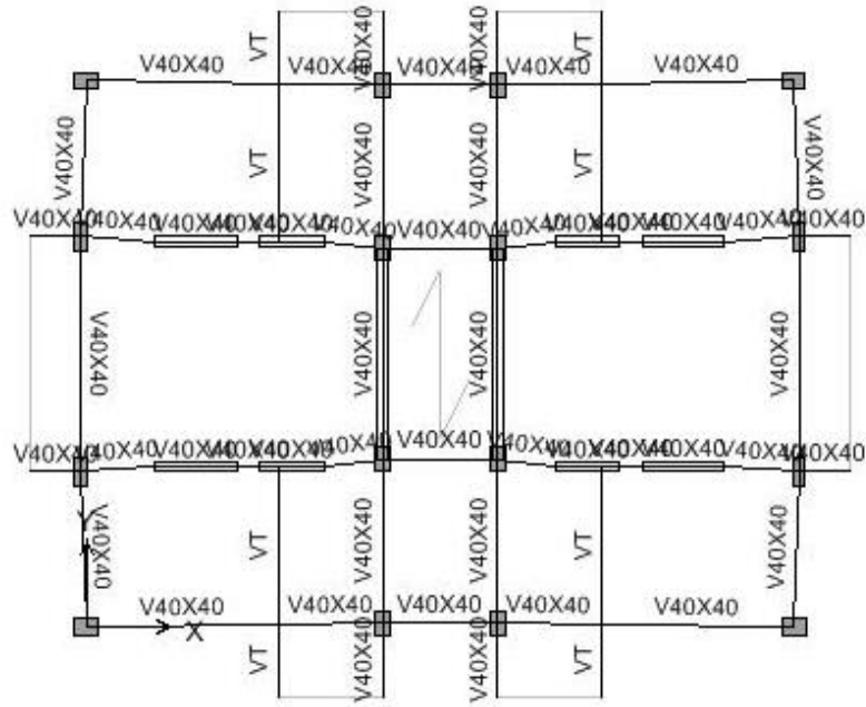
Figura 38. VIGAS PLACA PISO TIPO
