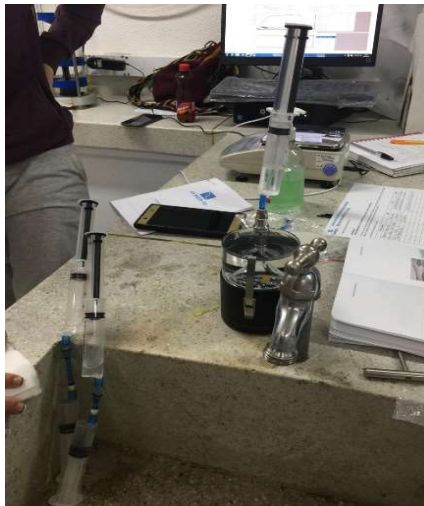
Figura 39. Llenado del sensor Fuente: Meter Group AG. (2016)
