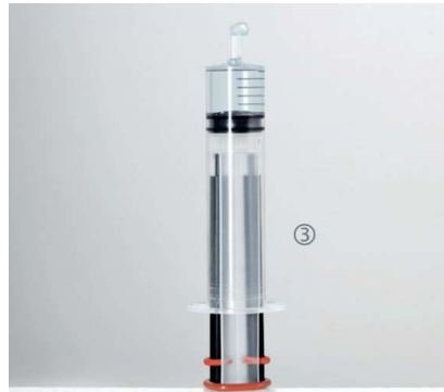
Figura 47. Remoción de aire residual del sistema Fuente: Meter Group AG. (2016)
