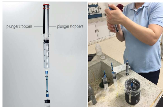
Figura 45 Retenedores para la jeringa de vacío Fuente: Meter Group AG. (2016)
