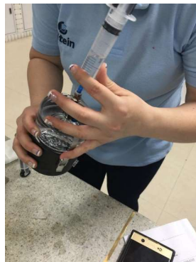
Figura 48 Llenado del depósito del sensor Fuente: Meter Group AG. (2016)
