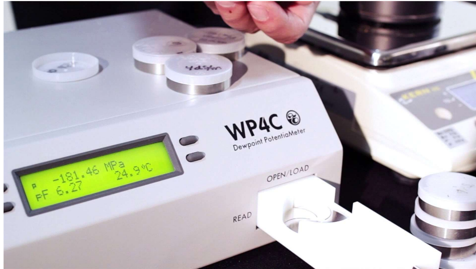
Figura 27. Higrómetro de punto de rocío Fuente: (Decagon devices inc., 2014)
