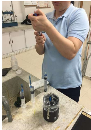
Figura 42. Generando vacío en las jeringas Fuente: Meter Group AG. (2016)
