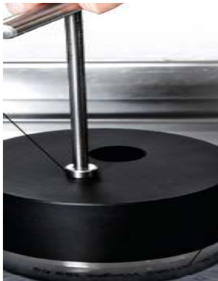
Figura 50. Preparación de la muestra para ensamblaje Fuente: Meter Group AG. (2016)
