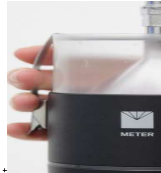
Figura 49. Llenado del depósito del sensor Fuente: Meter Group AG. (2016)
