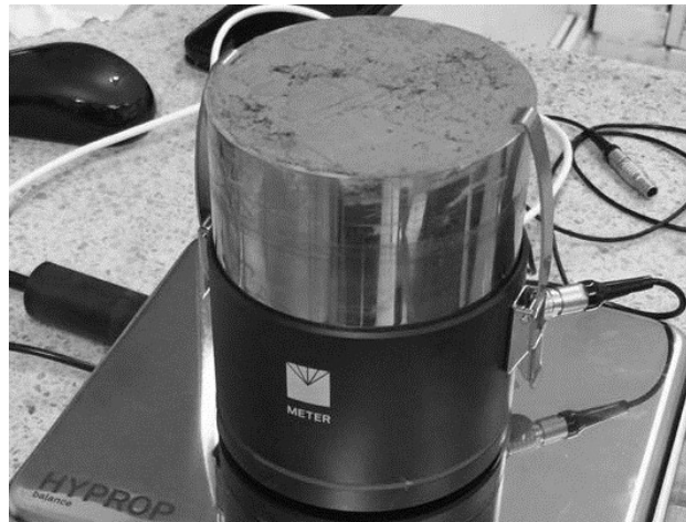
Figura 34. Preparación de la muestra – molde con disco de saturación, papel filtro y tapa Fuente: Elaboración propia, 2019
