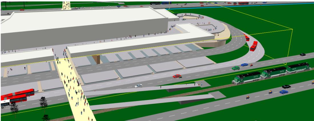
Integración modo Tren de Cercanías mediante puente peatonal a segunda planta
