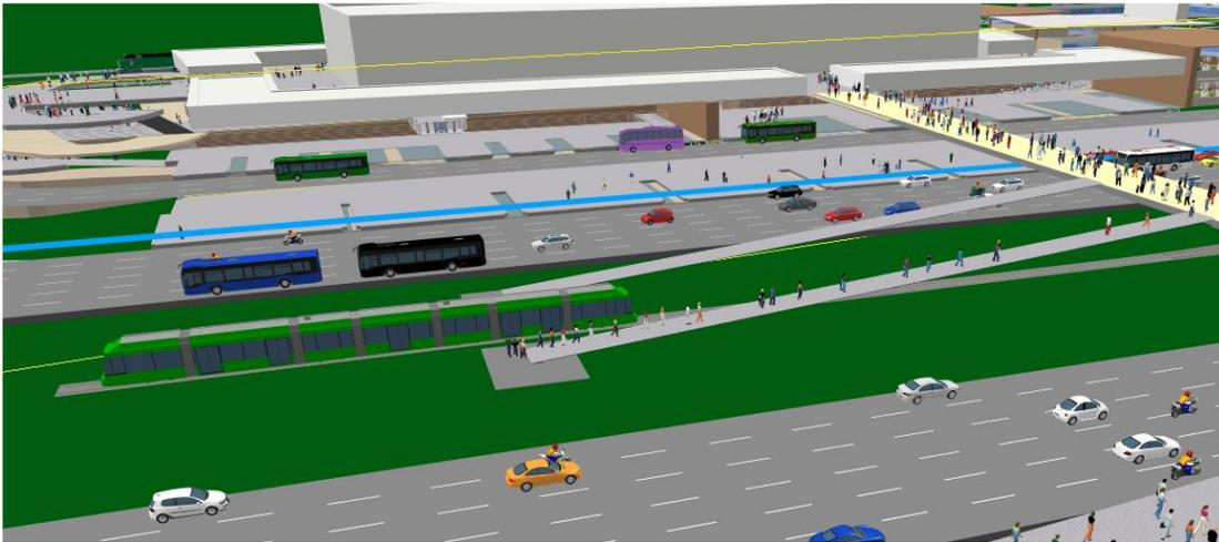
Integración modo Metro mediante puente peatonal a segunda planta
