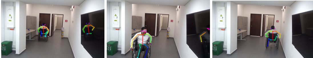
Fig. 22. Cuadros donde el video capturado con el módulo de cámara de la Raspberry (h264) predijo a) la posición de las extremidades inferiores obstaculizadas por la silla, b) los puntos cercanos a los tobillos cuando están obstaculizados por la vista de la cámara, c) predijo la posición de las extremidades obstaculizadas por la silla de ruedas. También se puede ver que el televisor refleja la imagen y distorsiona los datos verdaderos.
