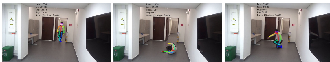
Fig. 19. Resultados del video capturado formato MTS(cámara Sony), a) cuadro de inicio, b) final del video, y c) primer cuadro de detección de caída.
