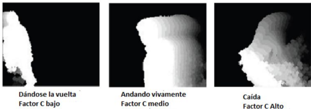
Fig. 7. Sistema de caída implementado por la Escuela de Ingeniería Eléctrica y de Computación de Georgia, basado en la segmentación de la persona en el cuadro. Píxeles negros son el fondo, los blancos son la persona, los grises se generan con el movimiento. 7
