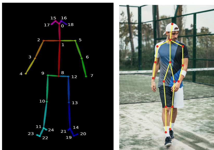
Fig. 4. Los modelos de detección de pose permiten determinar puntos próximos a las articulaciones y partes del cuerpo, que son de interés de la persona o personas presentes en el cuadro para determinar su postura. 4
