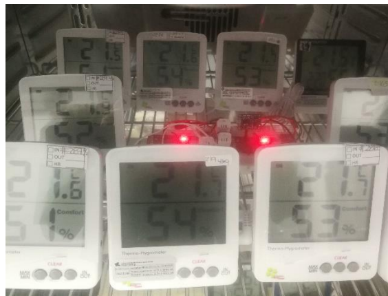
Figura 7. Calibración de sensores en el prototipo de prueba.
