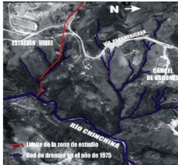
Figura 26 Fotografía aérea No2 de la Vertiente norte del río Chinchiná Año 1975. Área donde se localizan los 12 rellenos objeto de análisis (Osorio Sierra & Zuluaga Moreno, 2003)
