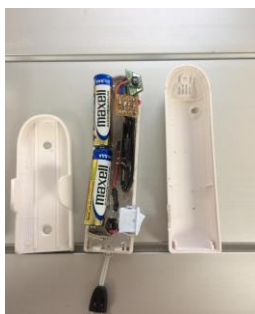
Figura 10. Prototipo con baterías alcalinas AAA, módulo ESP8266s-01, interruptor y sensor SHT11.
