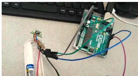
Figura 11. Prototipo con baterías alcalinas AAA, módulo en arduino (Comunicación Serial), Interruptor y sensor SHT11.
