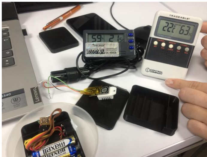
Figura 28. Comparación de medidas entre termohigrómetros y sensor de NidoApp.
