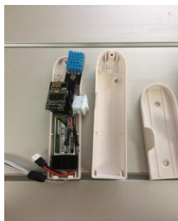
Figura 9. Prototipo con batería LiPo, módulo ESP8266s-01, interruptor y sensor DHT11.
