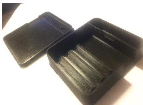
Figura 17. Resultado de impresión 3D de la carcasa y tapa para el sensor en PLA.
