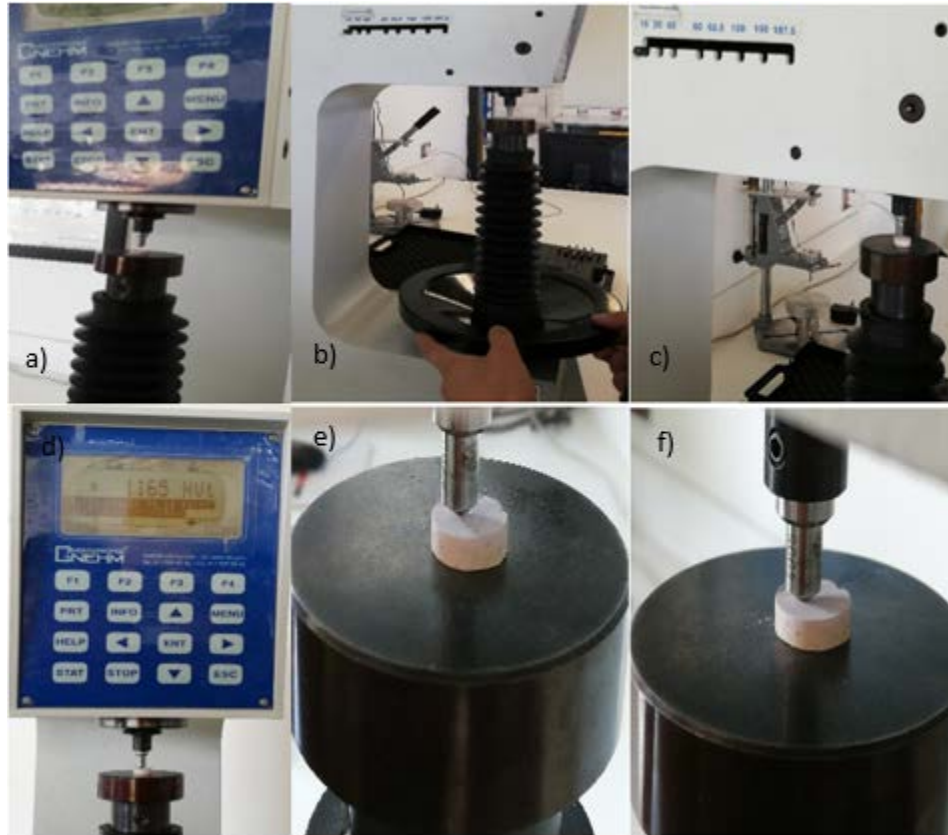
Ilustración 17. Proceso para los ensayos mecánicos, bajo la prueba de dureza de Vickers, con 15 N.
