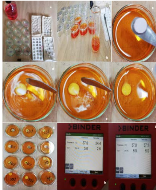
Ilustración 15. Proceso de pruebas de bioactividad. a materiales utilizados, b distribución de la solución de Hank, de la ilustración c a la f se aprecia la colocación de las probetas al interior de dicho medio, g rotulación de los andamios programación de la incubadora, i momento en que esta llega a las condiciones iniciales.
