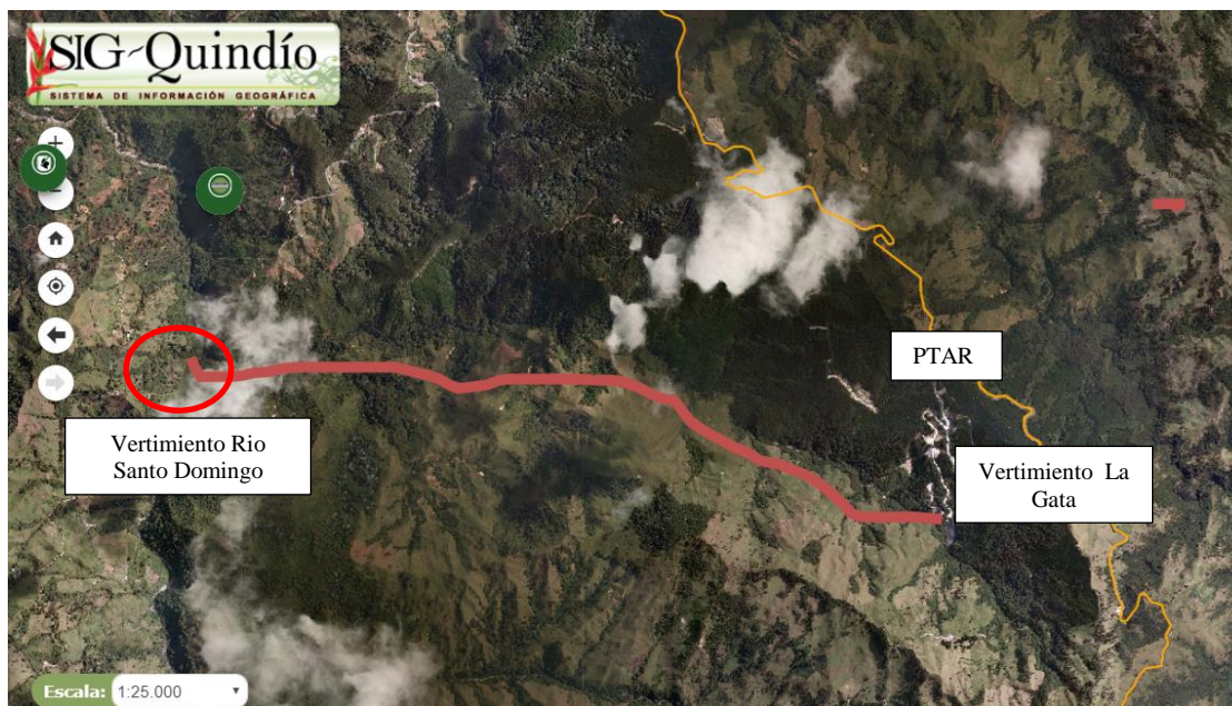
Figura 4-2 Línea de aducción de descarga desde la PTAR hasta el punto de vertimiento
