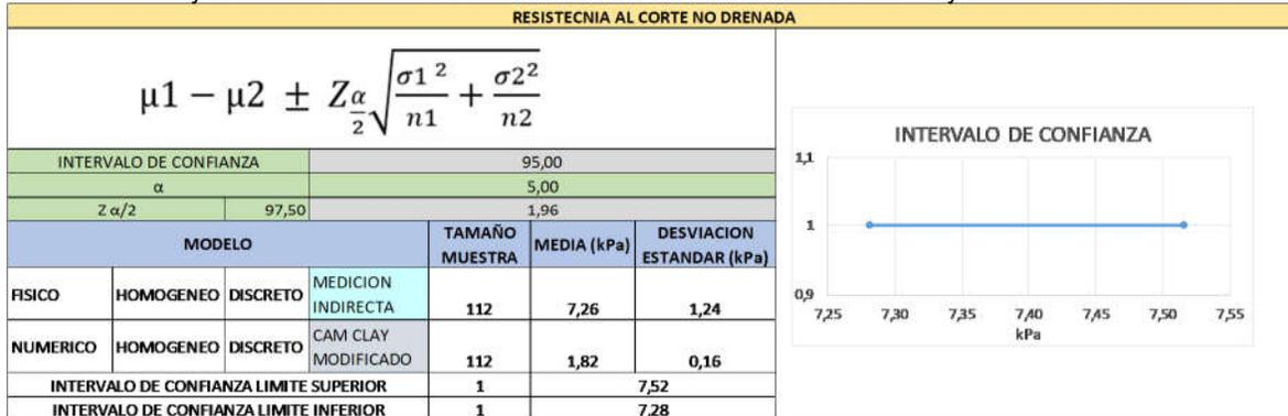
**Análisis comparativo entre los resultados determinados con mediciones directas en el modelo físico homogéneo construido con técnica discreta y los resultados obtenidos en los modelos numéricos homogéneos construidos con técnica discreta.**
