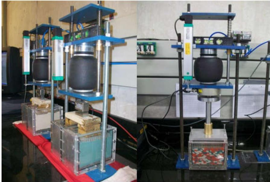
**Figura 19.** Consolidómetro neumático utilizado para etapa de consolidación edométrica. Fuente (Garzón, 2010).
