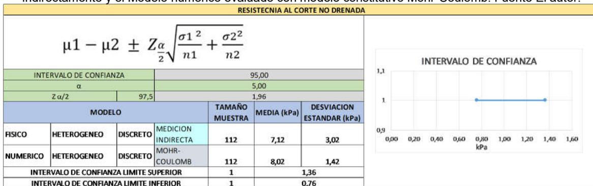
De acuerdo con los resultados se tiene que la diferencia de la resistencia al corte no drenada obtenida con técnica de medición indirecta del modelo físico heterogéneo y los resultados del modelo numérico heterogéneo construido con modelo constitutivo Mohr-Coulomb estará entre 0.76 kPa y 1.36 kPa para un intervalo de confianza del 95%.
