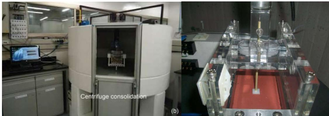
**Figura 20.** Modelo instrumentado e instalado en la centrífuga. Fuente (Garzón, 2014).
