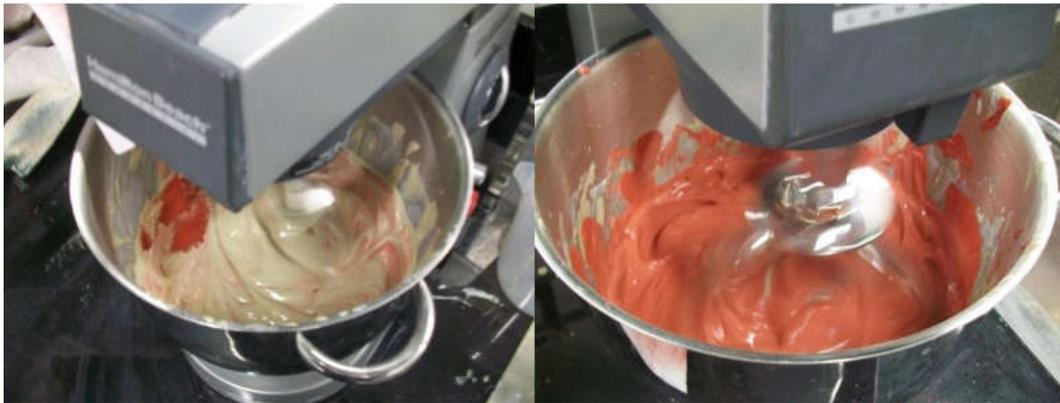
Figura 17. Ejemplo de preparación de mezclas de suelo en laboratorio. Fuente (Garzón, 2010).
