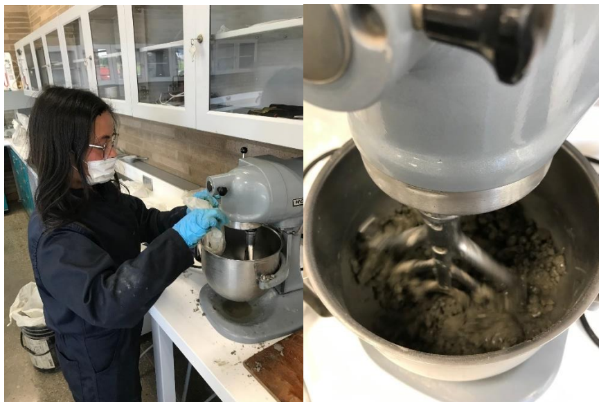
Figura 11. Proceso de mezcla de morteros
