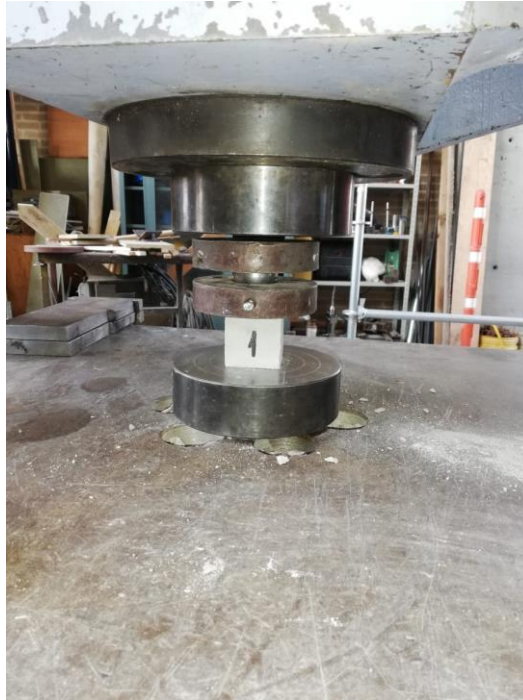
Figura 13. Montaje para la ruptura de cubos de mortero
