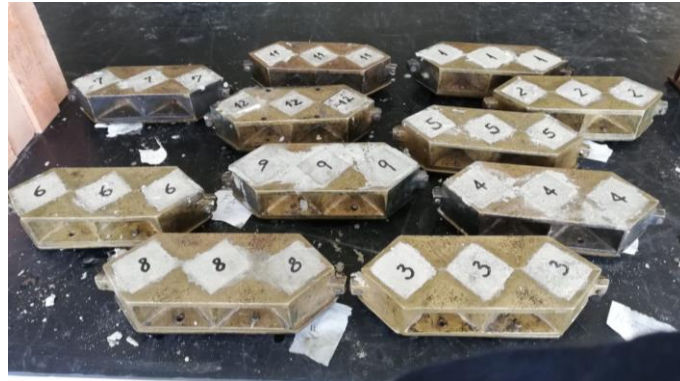
Figura 12. Cubos de morteros en moldes.
