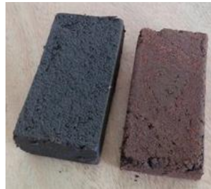
Figura 7. Ladrillos antes de cocción : De izquierda a derecha , 85CL-15CA y 90CL-10CA
