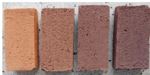
Figura 8. Ladrillos después de sinterización: de izquierda a derecha 100CL-0CA, 95CL-5CA, 90CL-10CA y 85CL-15CA
