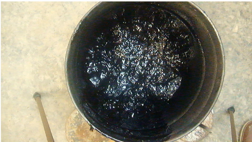
Figura D-1: Imagen de asfalto con 1.5% de humedad, temperatura de 140°C en t=30 seg
