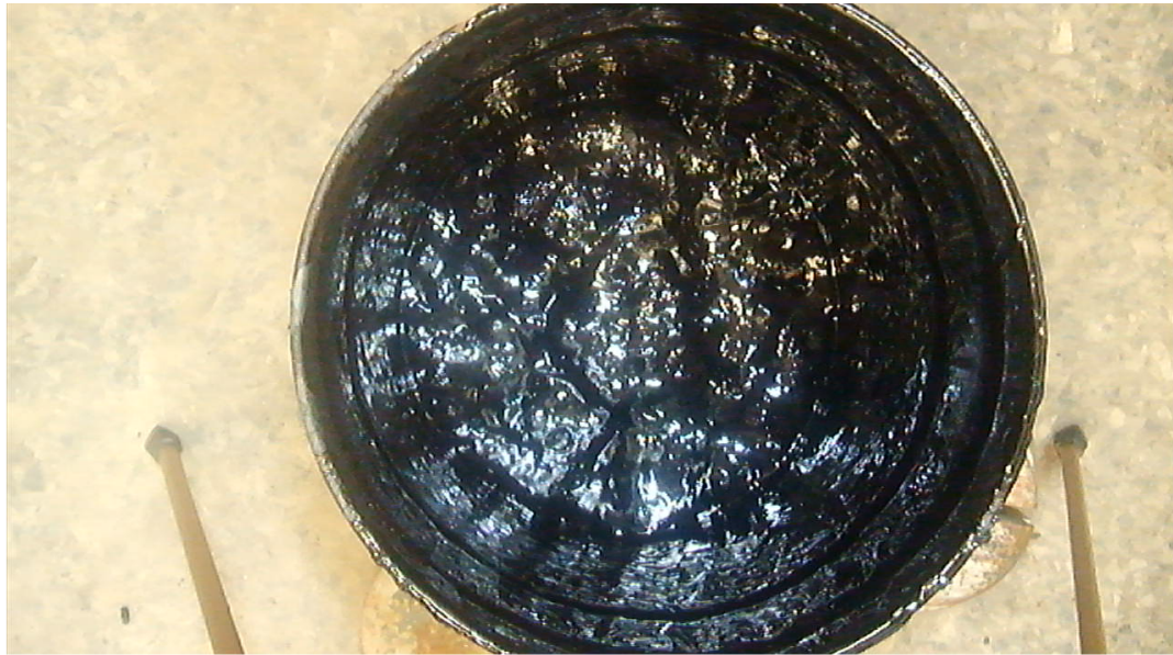
Figura D-2: Imagen de asfalto con 2.5 % de humedad, temperatura de 150°C en t=40 seg
