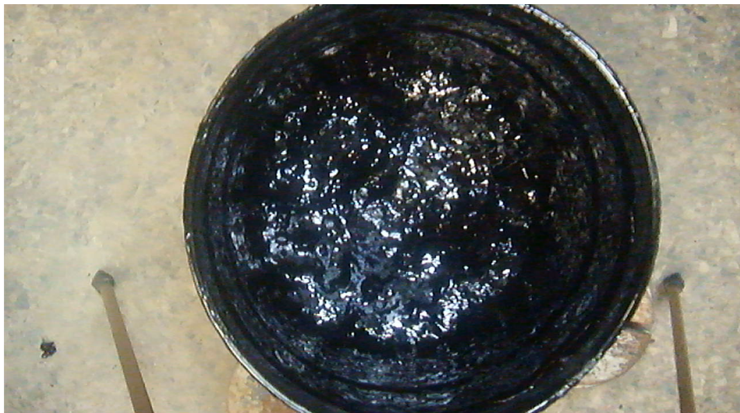
Figura D-3: Imagen de asfalto con 3.5 % de humedad, temperatura de 160°C en t=20 seg
