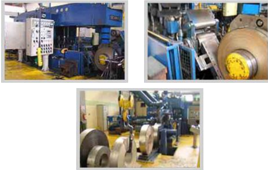
Figura No. 8 Laminador Schmitz. Sistema reversible de laminación en frío
