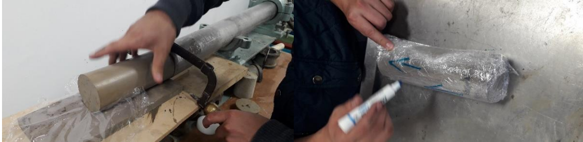
Figura 4.11 Extracción y almacenamiento de muestras tubo Shelby
