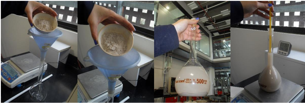
Figura C-01- 3 Procedimiento para determinación del Gs mediante un picnómetro
