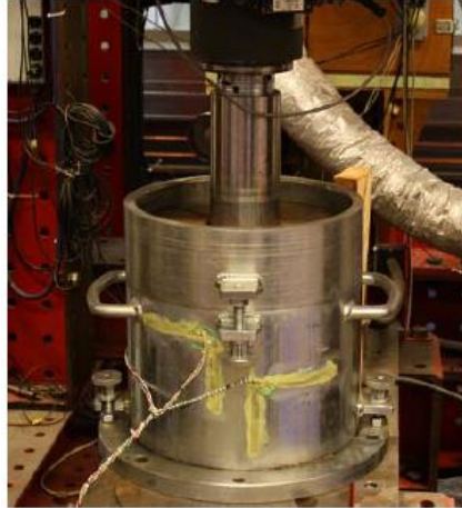
Figura 2.42 Ensayo de cCBR con medidores de deformación lateral
