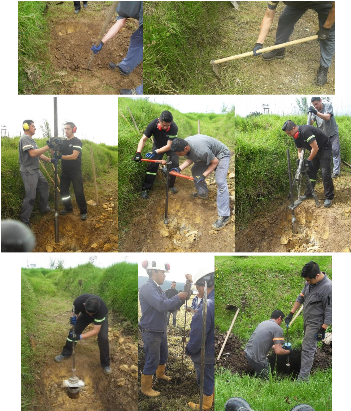
Figura 4.10 Exploración para obtención de muestras y ensayo de campo (PDC)
