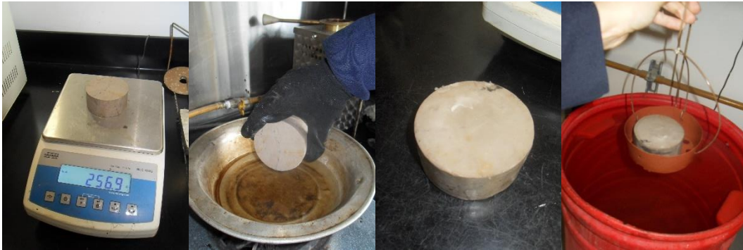
Figura C-01- 2 Procedimiento para la determinación del peso unitario de una muestra de suelo
