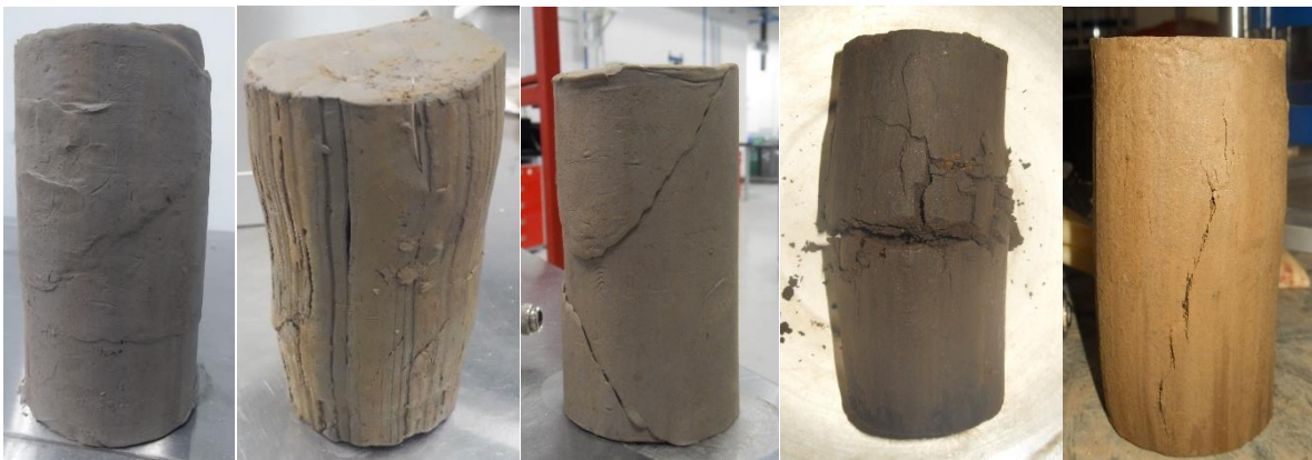
Figura 5.1 Muestras luego de la prueba rápida de corte del ensayo de Mr
