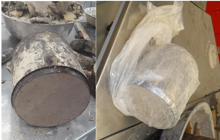
Figura 4.12 Almacenamiento muestra inalteradas de CBR
