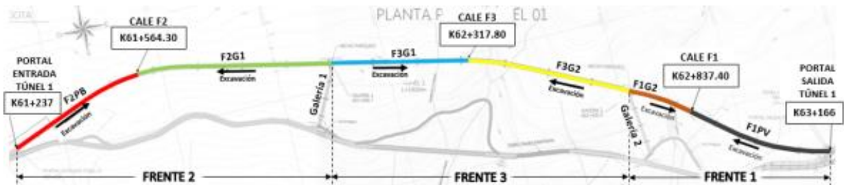
Figura 37. Distribución de los frentes de excavación. Fuente Consorcio Metroandina
