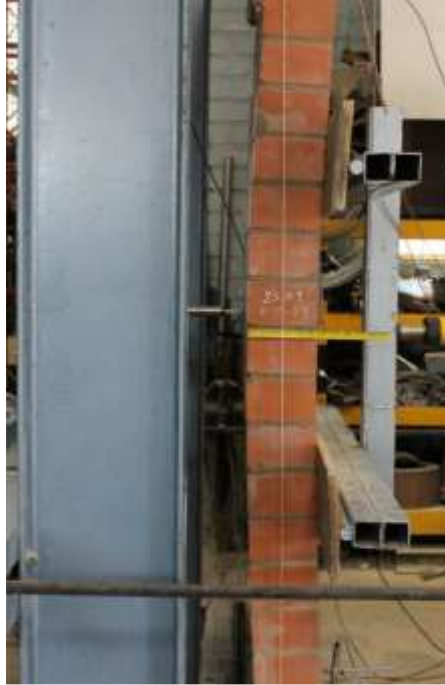
Figura 2-7: Carga aplicada al muro M1-G [4]
