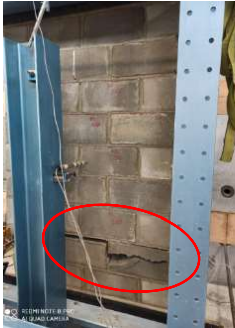
Fotografía 5-6 Falla a Tensión muro 5-2500-C-T-1,23- B.
