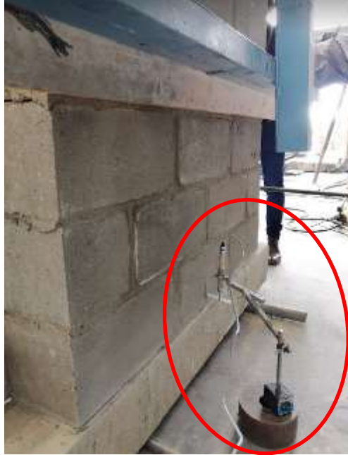
LVDT apoyo inferior – cara a compresión
