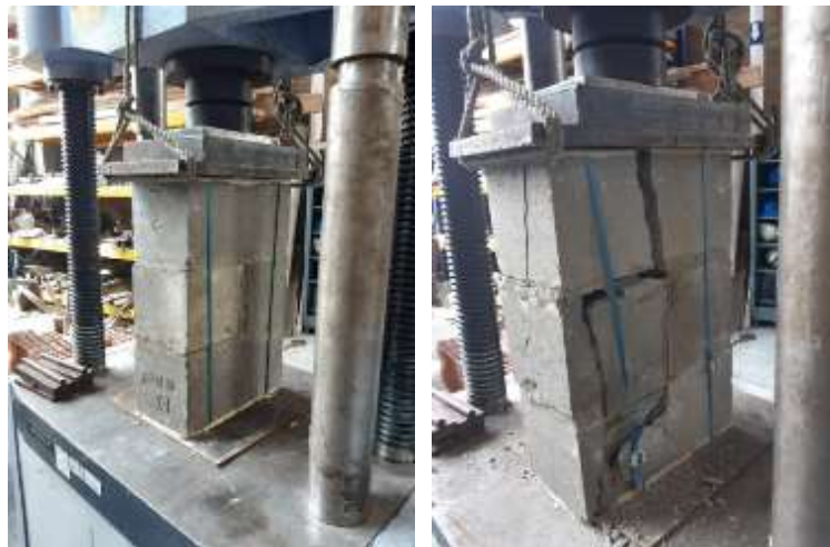
Fotografía 4-5 Montaje y ensayo de los muretes de mampostería
