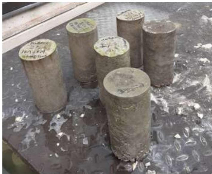
Fotografía 4-3 Elaboración cilindros de grout de relleno.
