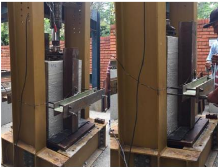
Figura 20. Configuración típica del ensayo de corte directo. Fuente: Hoyos (2015).
