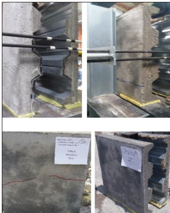
Figura 55. Fractura de losa y desprendimiento lámina colaborante
