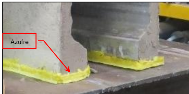
Figura 48. Detalle Homogenización base probetas. Fuente: Elaboración propia
