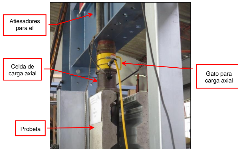
Figura 41. Gato y celda para carga axial. Fuente: Elaboración propia
