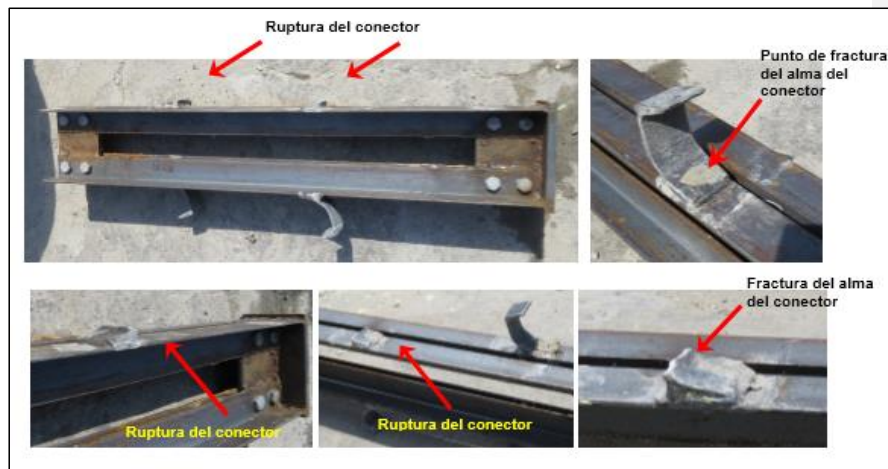
Figura 52. Fractura del alma del conector de cortante Fuente: Elaboración propia.
