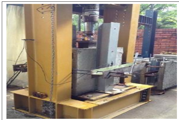
Figura 18. Configuración típica del ensayo de corte directo. Fuente: Hoyos (2015).
