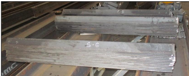
Figura 27272833 . Corte y perforación de ángulos. Fuente: elaboración propia.
