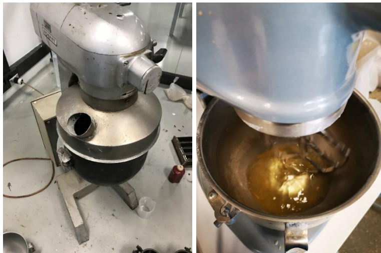
Figura 4-8: Mezcladora (izquierda). Mezcla de agua y superplastificante (derecha)
