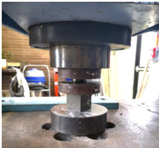
Figura 4-17: Montaje ensayo de compresión en cubos de concreto.
