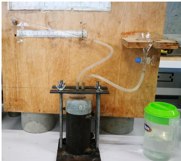
Figura 4-24: Montaje ensayo de absorción superficial inicial.
