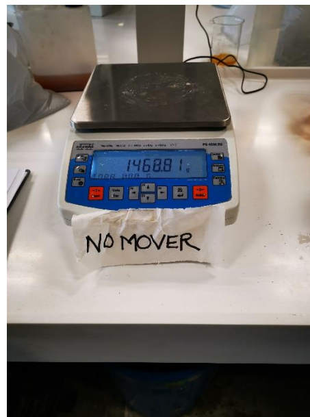
Figura 4-22: Peso de la muestra sumergida en agua para obtener peso D.
