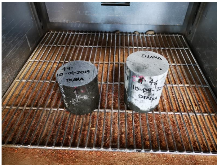
Figura 4-20: Muestras en horno a 110 °C para obtener peso A.
