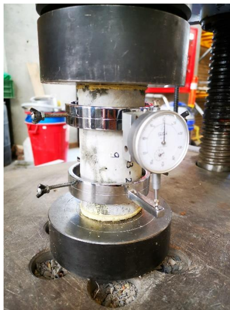
Figura 4-18: Montaje para ensayo de módulo elástico del concreto.
