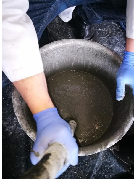
Figura 4-10: Consistencia del material al final de la dosificación.
