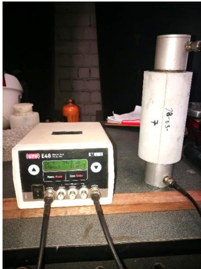
Figura 4-19: Ensayo de medición de velocidad de pulso ultrasónico.
