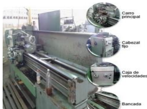
Figura 22 Mantenimiento de Sistemas de un torno
