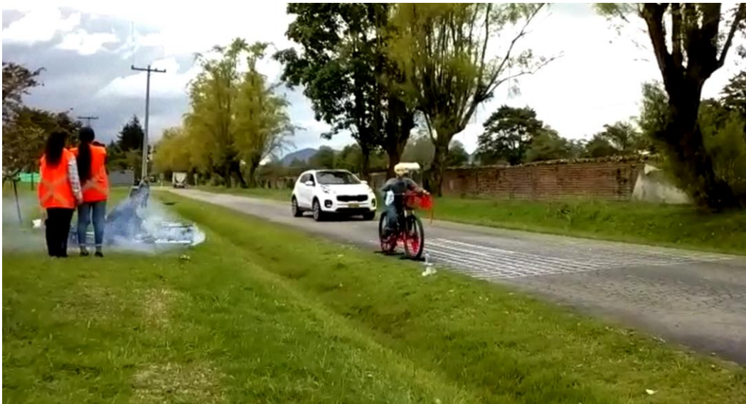
Figura 14. Imagen de campo de la prueba preliminar No 1, donde se aprecia el vehículo 1 de prueba, maniquí de prueba, cuadrícula, recurso humano, cámara de humo, entre otras.
