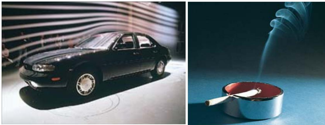
Figura 7. Imagen costado izquierdo: Flujo laminar alrededor de un automóvil en un túnel de viento; imagen costado derecho: Los gases calientes de un cigarrillo se hacen visibles mediante partículas de humo. Primero el humo se mueve en flujo laminar en la parte baja y luego en flujo turbulento arriba. Fuente: Serway – Jewett Física para ciencias e Ingeniería Volumen 1 Séptima edición
