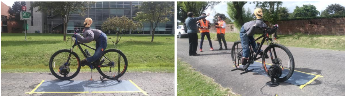
Figura 16. Imagen de campo de la prueba preliminar No 2, la imagen de la izquierda se observa una vista lateral del vehículo 2 (bicicleta), la cuadrícula de prueba (1x1cm), la cinta satén de color azul y la punta en figura flecha color naranja y el ventilador de aspas; en la imagen de la derecha, es una continuación, en otro ángulo donde se observa el ventilador de aspas, el vehículo 2 y la cuadrícula de prueba, entre otras.
