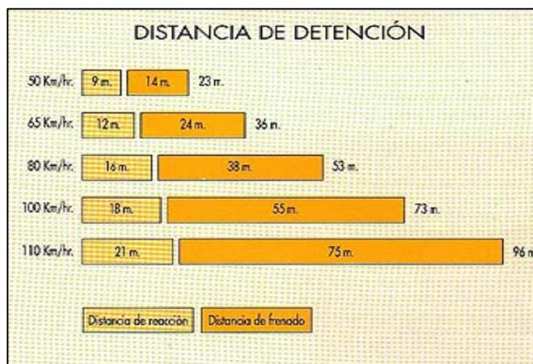
Figura 12. Distancias de reacción y frenado para diferentes velocidades en pendiente y pavimento seco y buenas condiciones.
